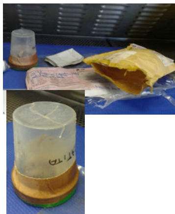
Figura 3. Frasco partido por ter sido enviado em envelope, não devidamente acondicionado. A informação ficou também danificada por não estar separada do conteúdo.
