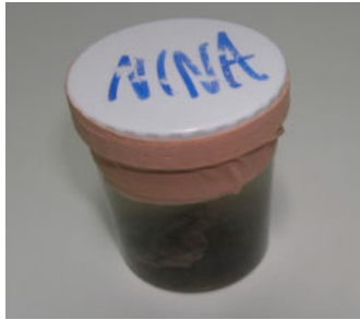
Figura 4. Identificação incorreta: na tampa e com tinta não indelével, que é facilmente removida com a manipulação.
