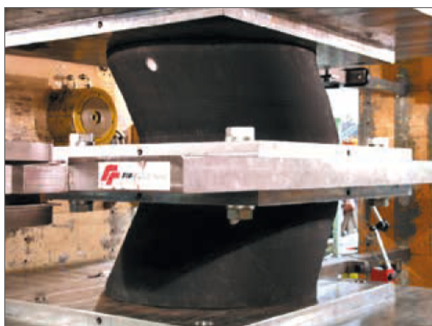
Figura 5.6: Teste de corte em HDRB (FIP, 2016)
