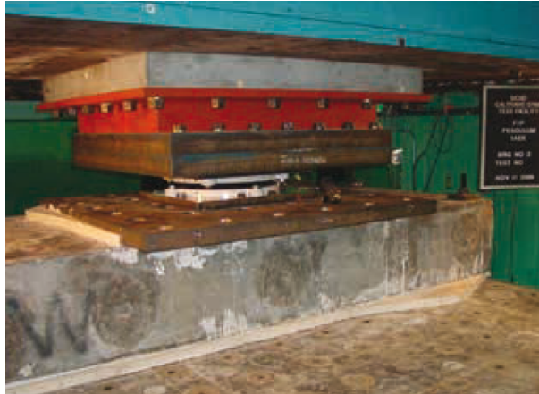
Figura 5.17: Ensaio bidirecional na máquina SRMD Test Facility (Universidade da Califórnia) (FIP, 2016)
