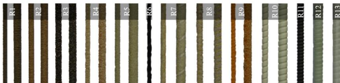
Figura 3: Superfícies de varões de FRP (Başaran et al. , 2022).
