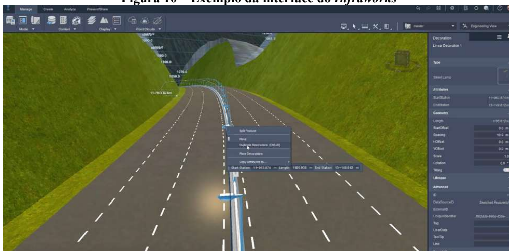
Figura 10 – Exemplo da interface do Infraworks
