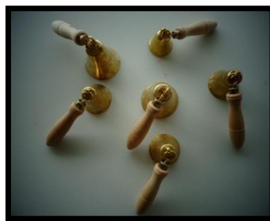
Figura 28 Construção das sinetas (Sinetas, grampos e cabos de madeira).
