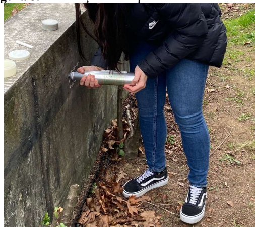
Figura 39: Execução do impacto com o esclerômetro
