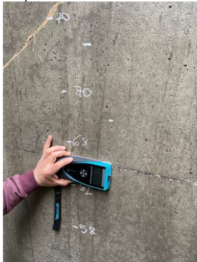
Figura 35: Posicionamento do pacômetro durante o ensaio e os recobrimentos identificados
