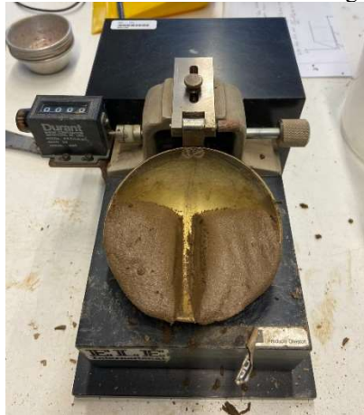
Figura 40: Amostra na concha de Casagrande
