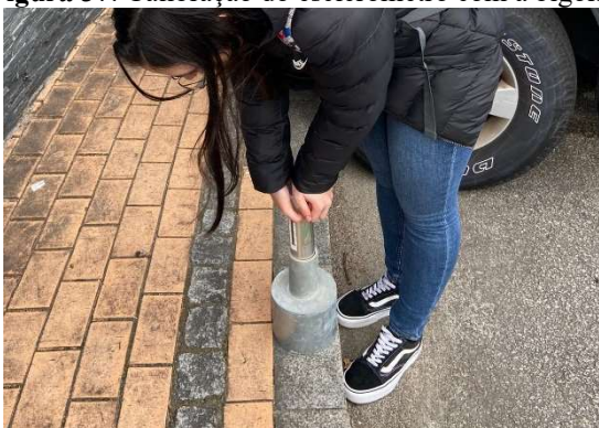
Figura 37: Calibração do esclerômetro com a bigorna
