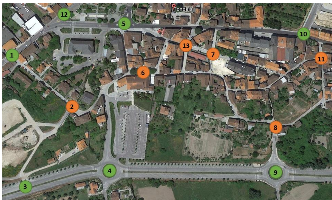
Figura 9 – Postos de contagem de tráfego (postos de extremidade – verde; postos internos – laranja)
