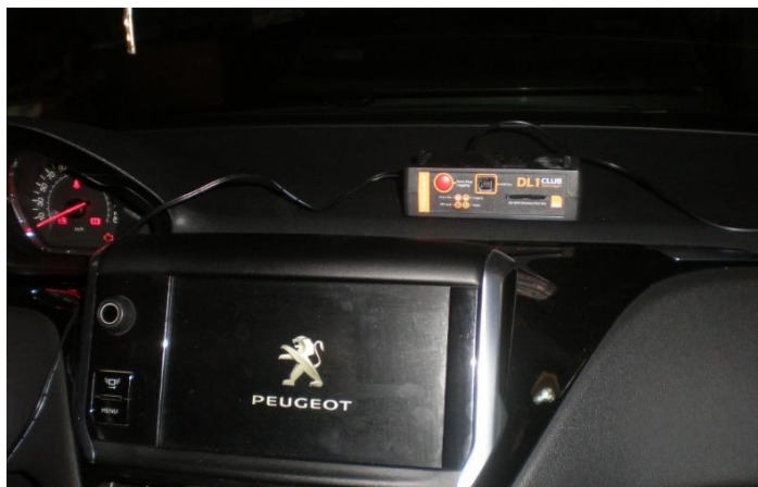
Figura 12 – Veículo equipado com o datalogger da Race Technology Ltd (Modelo DL1 MK3)
