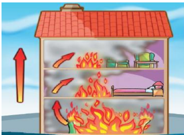
Figura 2-4: Transmissão de calor por convecção. Extraído de (Cunha, 2010, 6)
