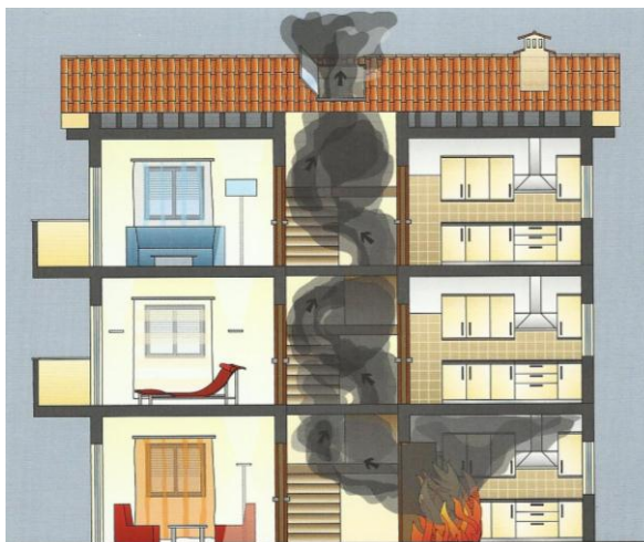
Figura 2-6: Efeito de chaminé. Extraído de (Castro et al , 2009, 73)
