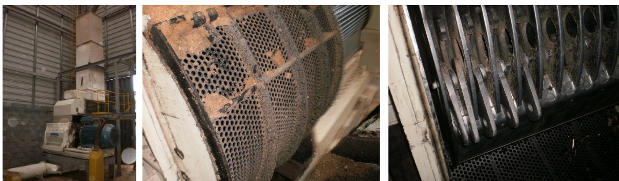
Figura 2: Moinhos de Martelos (Fotografia captada na empresa Pinewells -Arganil).
