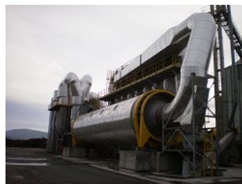
Figura 1: Secador de Tambor Rotativo (Fotografia captada na empresa Pinewells -Arganil).
