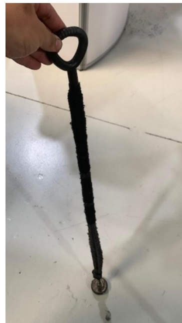
Figura 36: Ferramenta de atração de parafusos e porcas
