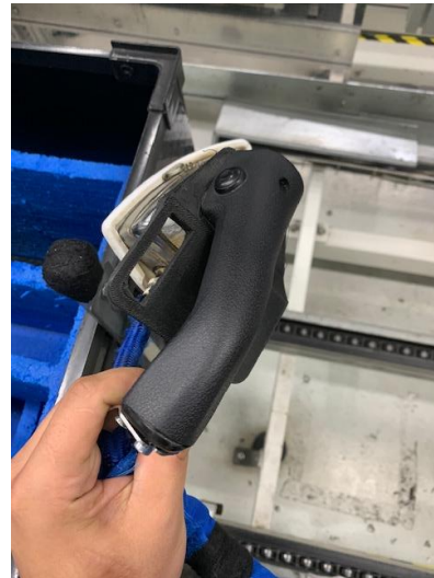
Figura 46: Base protetora do ferro DEPOIS
