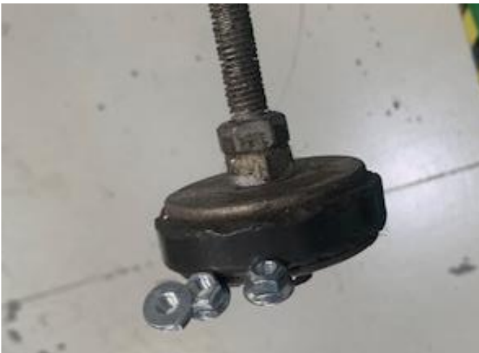
Figura 35: Base magnética para atração de parafusos e porcas
