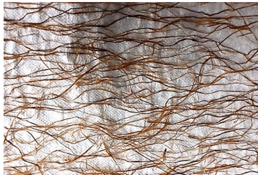
Figura 22 – Fibras mercerizadas secas.
