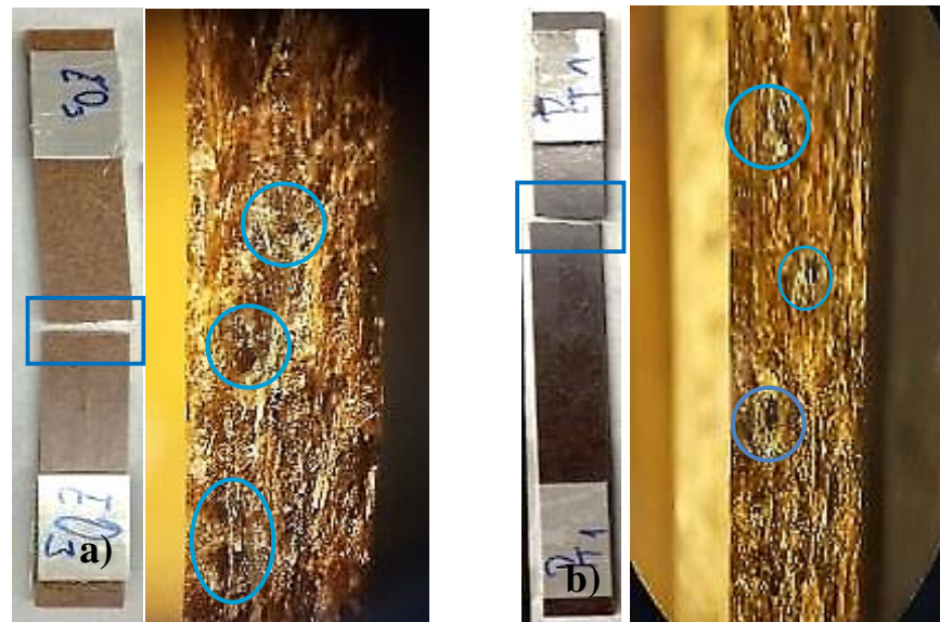
Figura 45 – Zona de fratura dos provetes reforçados com fibra macerada (a) e fibra mercerizada (b)
