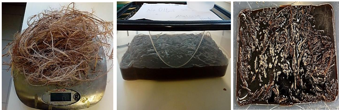
Figura 20 – Tratamento alcalino de hidróxido de sódio
