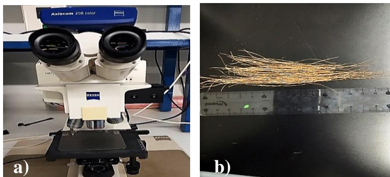
Figura 24 – a) Microscópio da Carl Zeiss , Axiotech 100HD, b) Medição do comprimento das fibras
