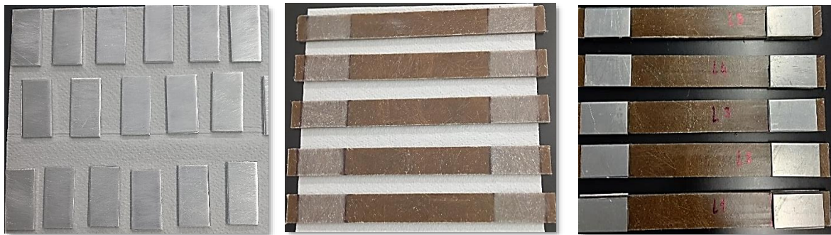
Figura 35 –Placas de alumínio coladas nas extremidades dos provetes
