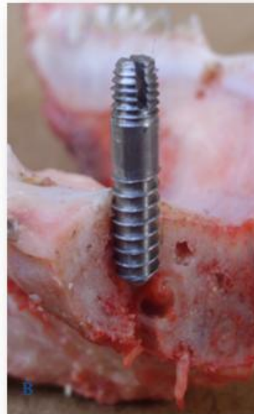
Figura 2.19. A) Ilustração do implante M5x25x1,5 mm com rosca quadrada com profundidade de perfil igual a 0,49 mm em 2D; B) Fotografia em corte da mandíbula após a inserção do implante M5x25x1,5 mm com rosca quadrada com profundidade de perfil igual a 0,49 mm.
