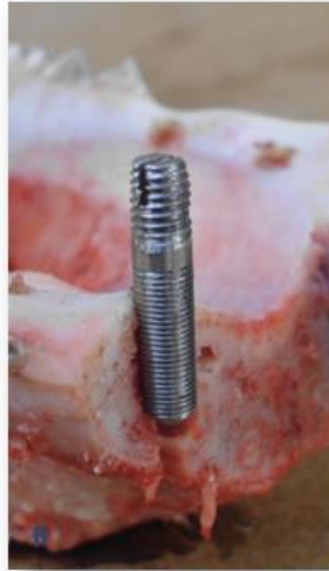
Figura 2.18. A) Ilustração do implante M5x25x0,5 mm em 2D; B) Fotografia em corte da mandíbula após a inserção do implante M5x25x0,5 mm.
