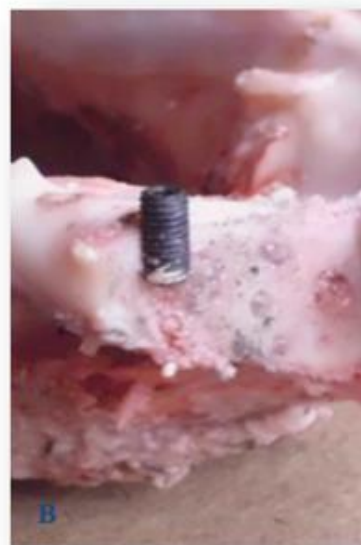
Figura 2.10. A) Ilustração do implante M4x10x0,7 mm em 2D; B) Fotografia em corte da mandíbula após a inserção do implante M4x10x0,7 mm.
