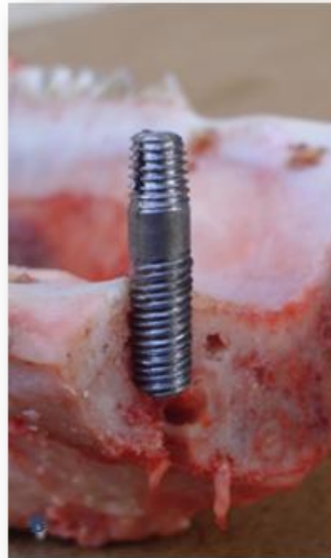
Figura 2.17. A) Ilustração do implante M5x25x0,83 mm com rosca múltipla de 3 entradas em 2D; B) Fotografia em corte da mandíbula após a inserção do implante M5x25x0,833 mm com rosca múltipla de 3 entradas.
