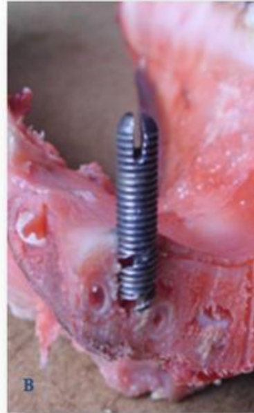
Figura 2.24. A) Ilustração do implante M5x25x0,8 mm, com efeito da hélice auto roscante, com passo exterior de 5 mm com espaço entre hélices de 1,5 mm e diâmetro interior de 2 mm em 2D; B) Fotografia em corte da mandíbula após a inserção do implante M5x25x0,8 mm, com efeito da hélice auto roscante, com passo exterior de 5 mm com espaço entre hélices de 1,5 mm e diâmetro interior de 2 mm.
