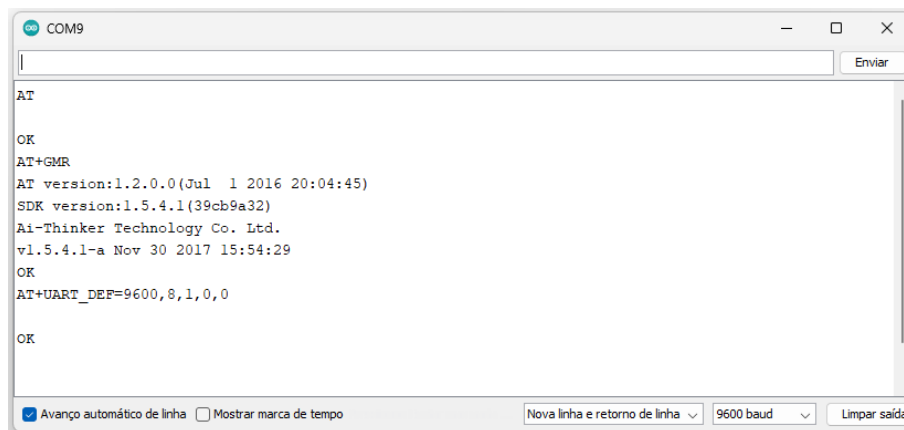
Figura 35 - Versão atualizada do firmware instalado no ESP8266-01
