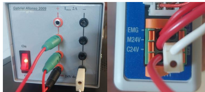
Figura 27 - Alimentação do driver do atuador elétrico horizontal
