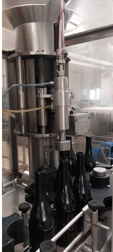
Figura 9 - Estação de trabalho, Rolhagem
