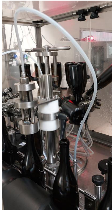
Figura 7 - Estação de lavagem das garrafas
