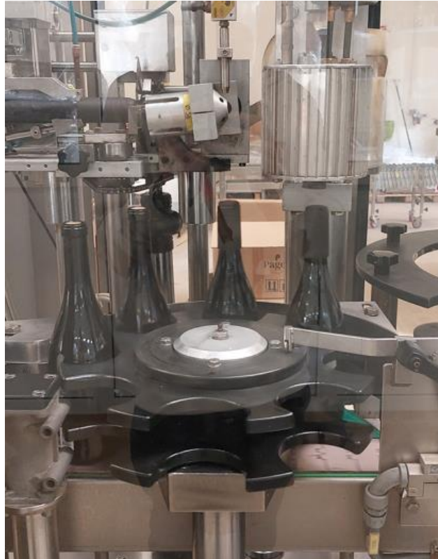
Figura 12 - Estação de trabalho, Capsulagem
