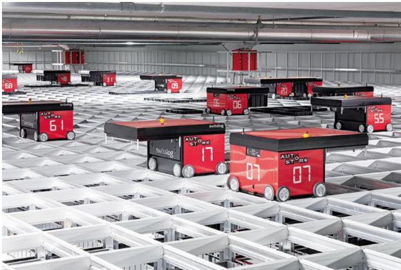
Figura 2-13: Robôs constituintes do sistema AutoStore [27].
