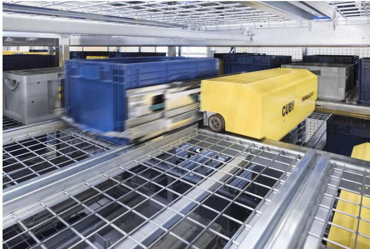
Figura 2-15: Mecanismo para depositar e recolher artigos das prateleiras [28].
