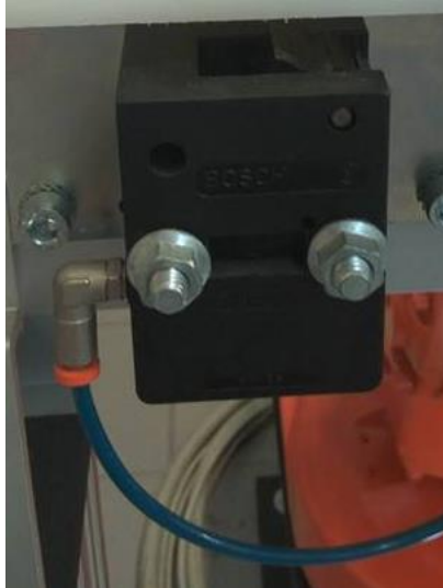
Figura 3-9: Stopper do setor do armazém.
