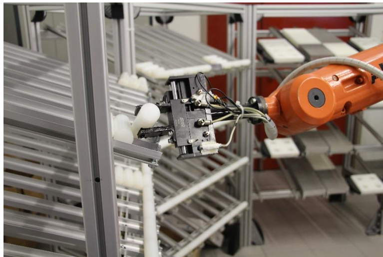
Figura 4-15: Peça transportada desloca as seguintes.
