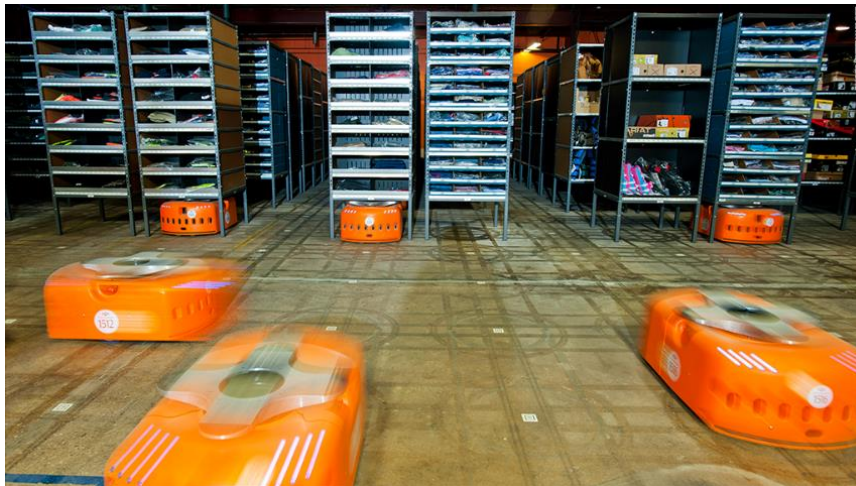
Figura 2-10: Robôs constituintes do sistema KIVA [25].
