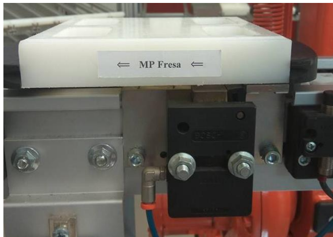
Figura 3-10: Stopper elevado para reter paleta.
