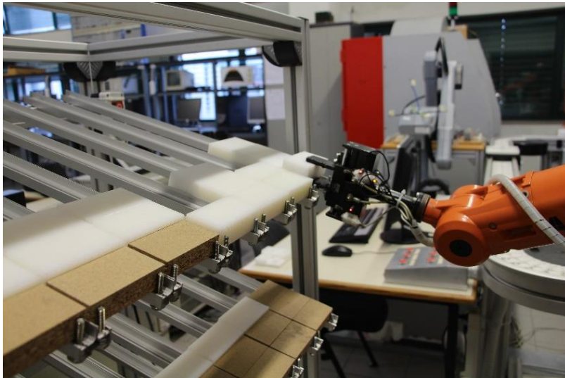
Figura 4-11: Peça transportada desloca as seguintes.
