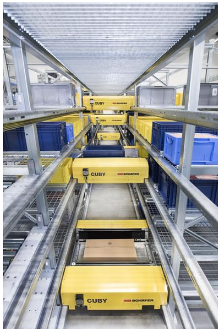
Figura 2-14: Robôs do sistema CUBY a deslocarem-se entre as prateleiras [28].
