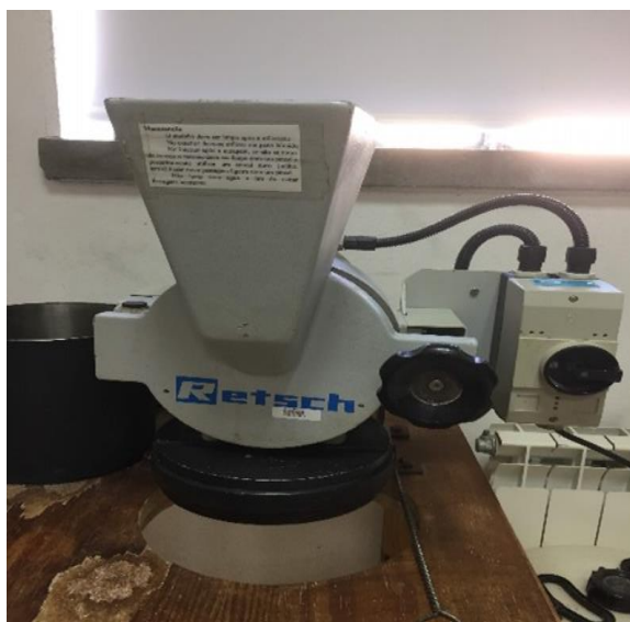
Figura 2 – Moinho de martelos (Retsch typ.)
