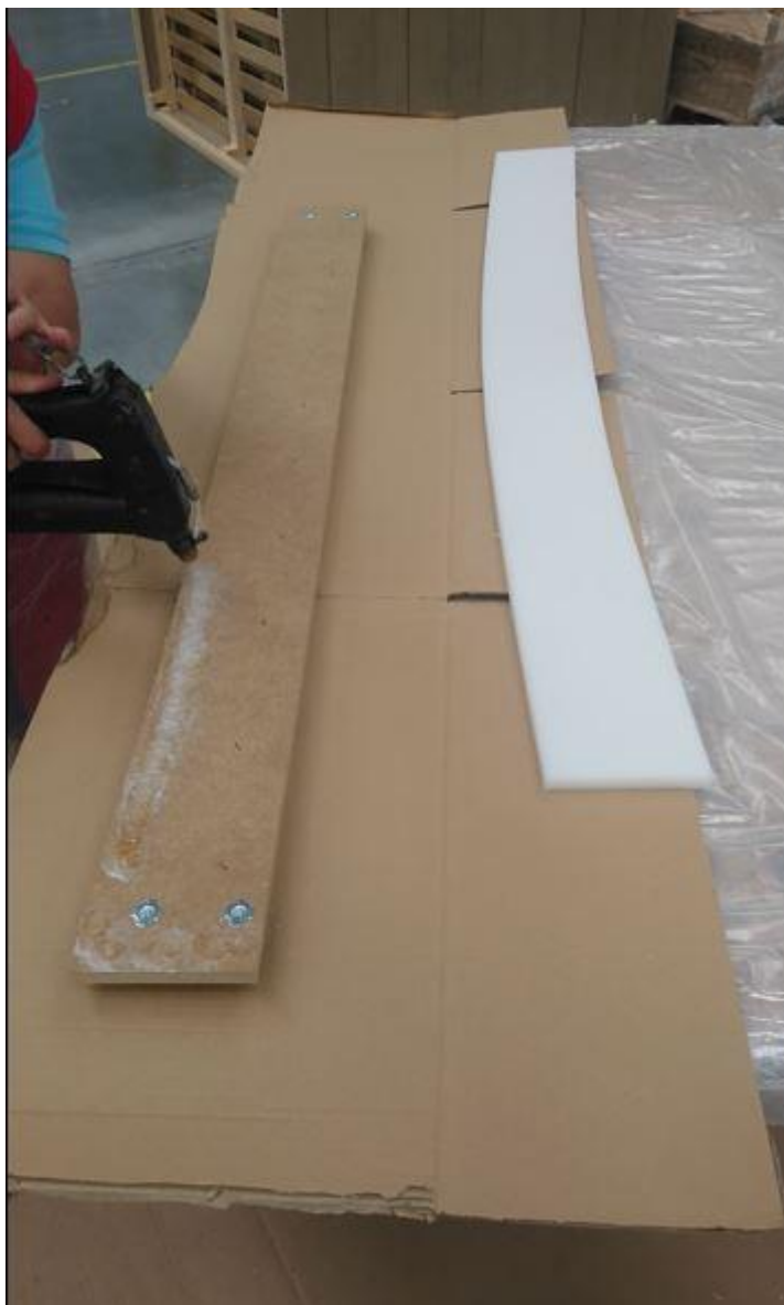
Figura 31 - Aplicação de cola para a colocação de espuma
