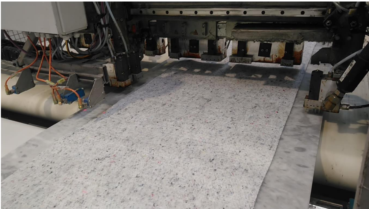
Figura 26 - Exemplo de uma parte de uma máquina de colagem com a colocação de feltro
