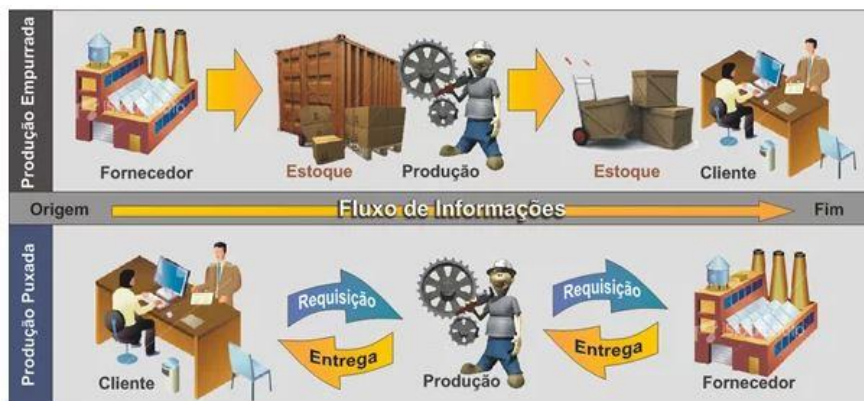
Figura 1 - Exemplo de um sistema PUSH – retirado de Raul 2015
