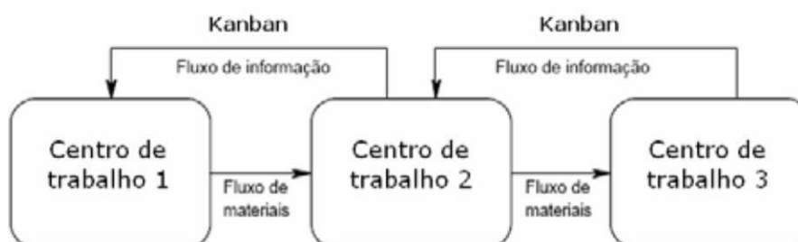
Figura 4 - Modo de funcionamento do sistema KANBAN, adaptado (Negocios 2021)
