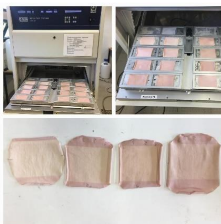
Figura 38 - Teste de Solidez da Cor à luz artificial é realizado na câmara de Xénon Q-SUN.
