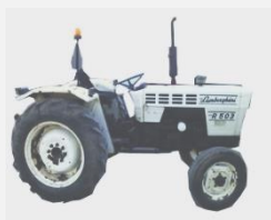
Trator agrícola. sem proteção para o condutor
