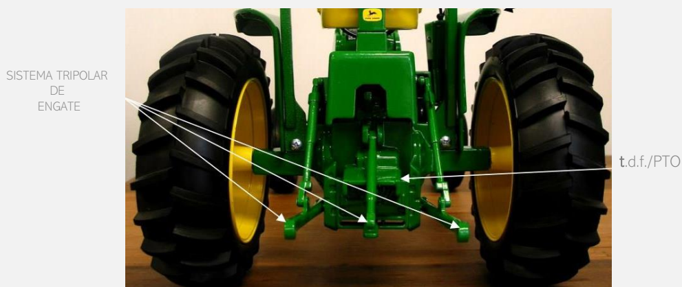
Figura 31 – Sistema tripolar de engate (traseiro). Três pontos (3P).
