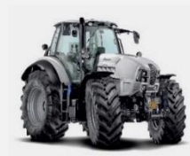
Trator agrícola com proteção ROPS na cabina
