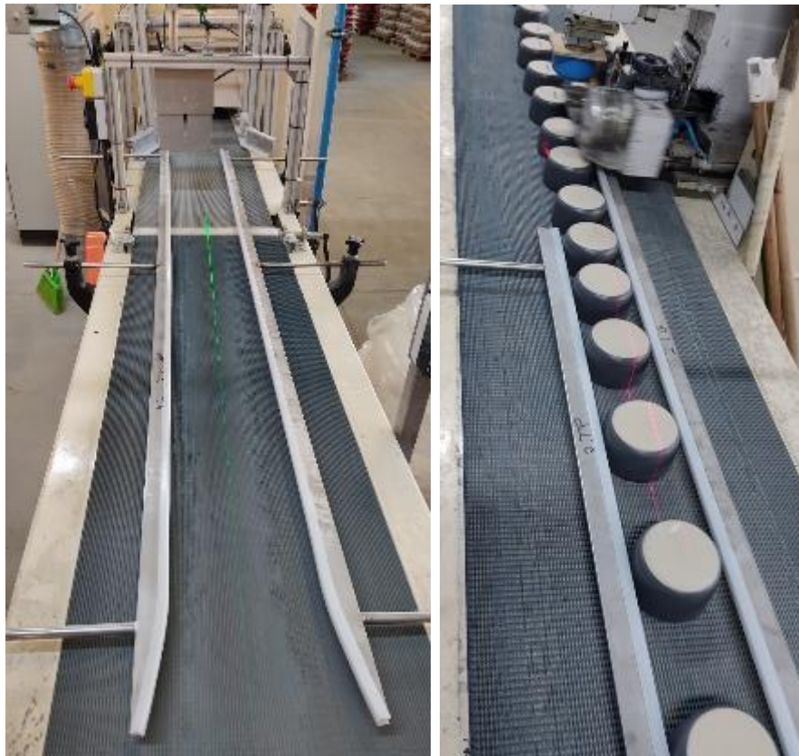
Figura 15 – Aplicação da guia de orientação da peça nas linhas
