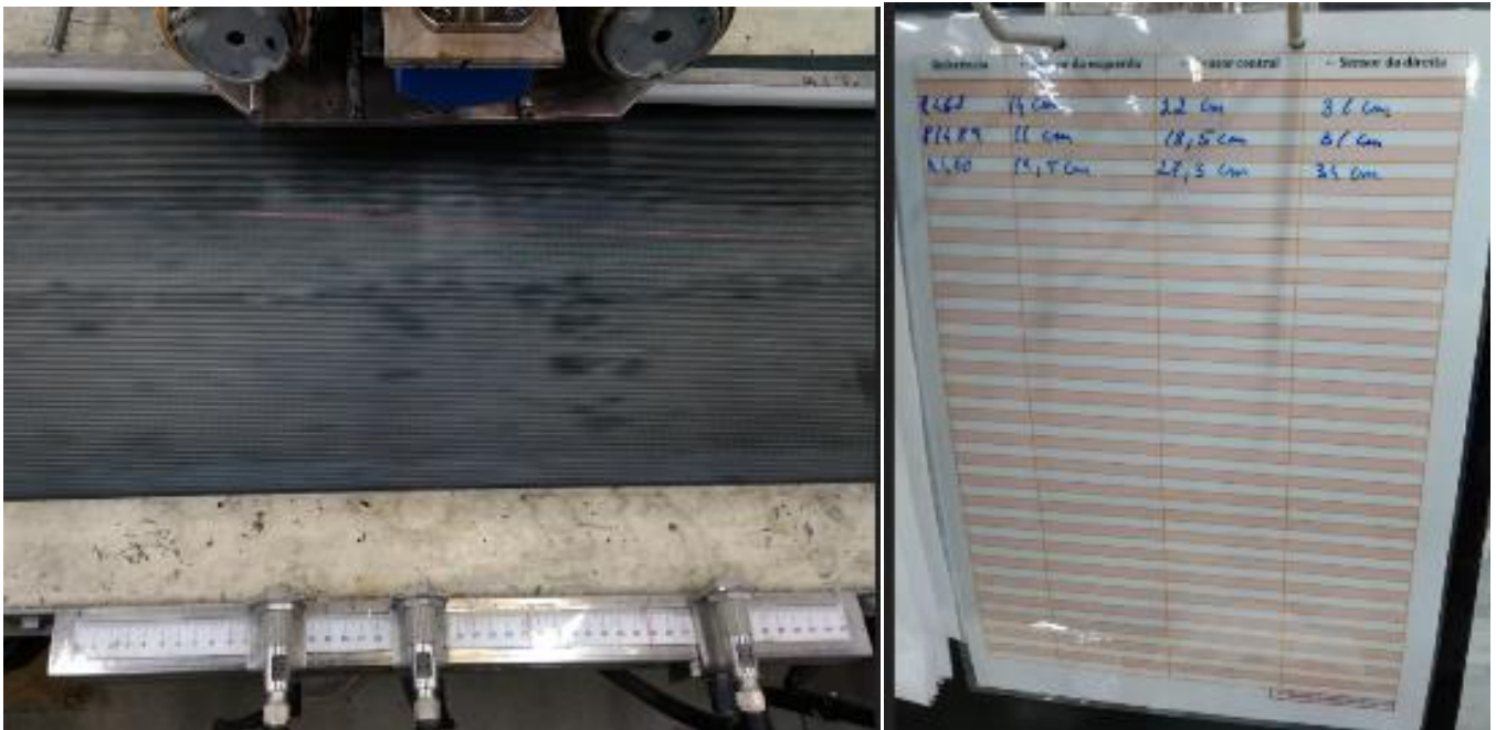
Figura 24 – Colocação de régua de medição para sensores e registo de medidas por referência
