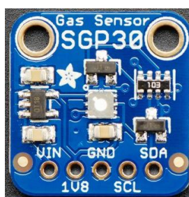
Figura 3-4: Sensor SGP30 (Adaptado de (Adafruit SGP30, 2019)).
