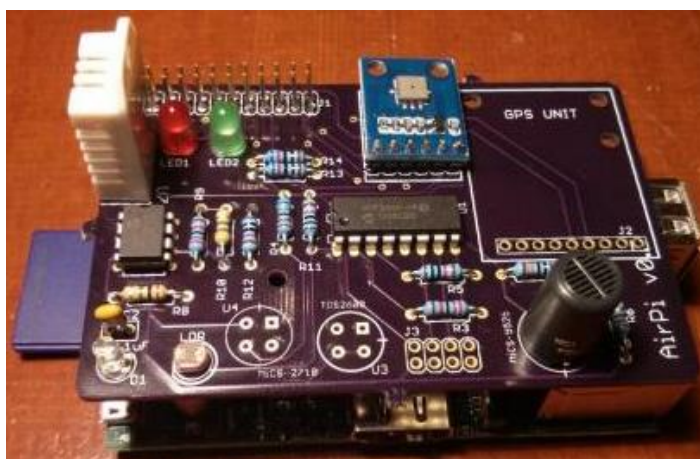
Figura 2-8: AirPi (Adaptado de (AirPi PCB, 2019)).
