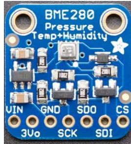
Figura 3-2: Sensor BME280 (Adaptado de (Adafruit BME280, 2019)).
