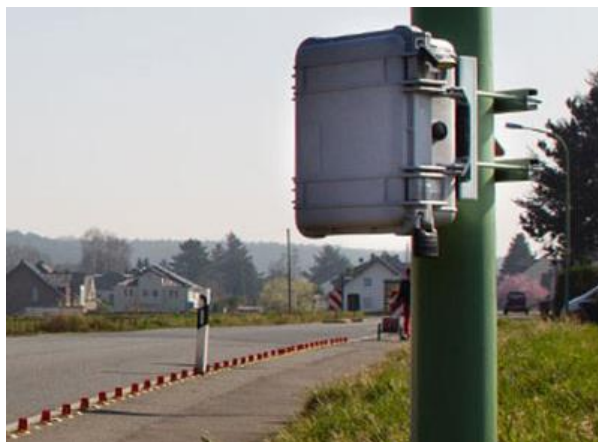
Figura 2-13: Solução SDR da Urban Aspect (Adaptado de (Urban Aspect SDR Traffic, 2019)).
