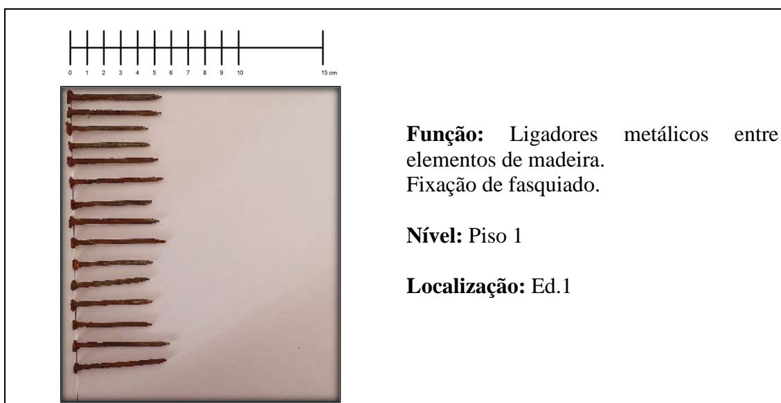
Figura 30: Ligadores metálicos de fixação de fasquiado do Ed.1, piso 1
