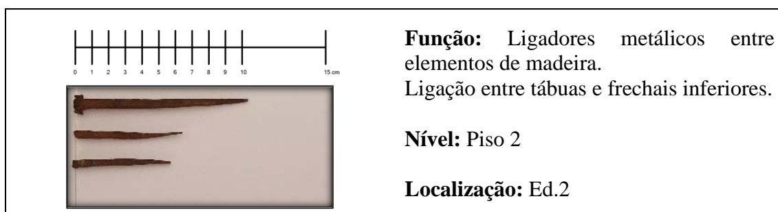
Figura 35: Ligadores metálicos de ligação entre tábuas e frechais inferiores do Ed.2, piso 2
