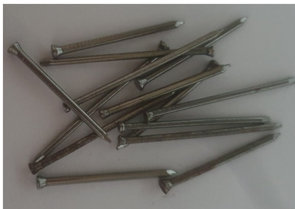
Figura 7: Ligadores metálicos fabricados
