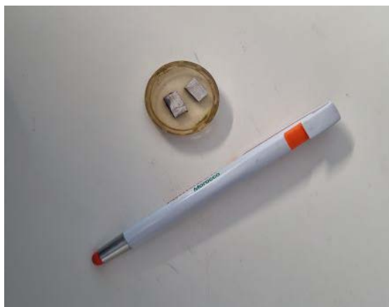
Figura 42: Molde das amostras com secção transversal – Molde 2
