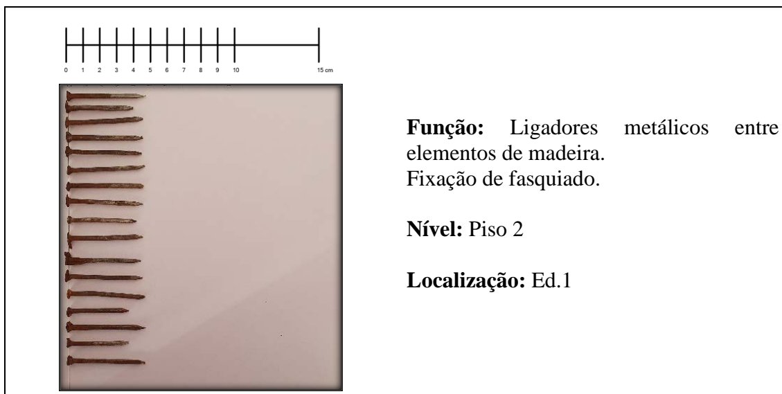
Figura 31: Ligadores metálicos de fixação de fasquiado do Ed.1, piso 2
