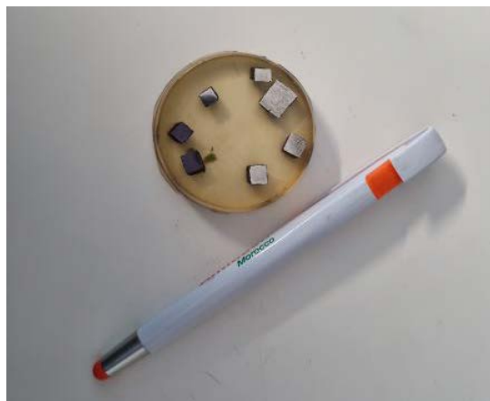
Figura 41: Molde com as amostras com secção longitudinais – Molde 1
