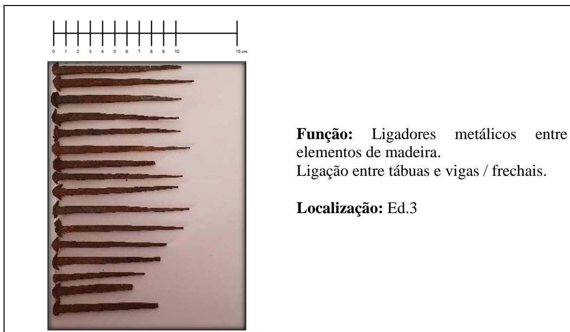
Figura 36: Ligadores metálicos de ligação entre tábuas e vigas / frechais do Ed.3
