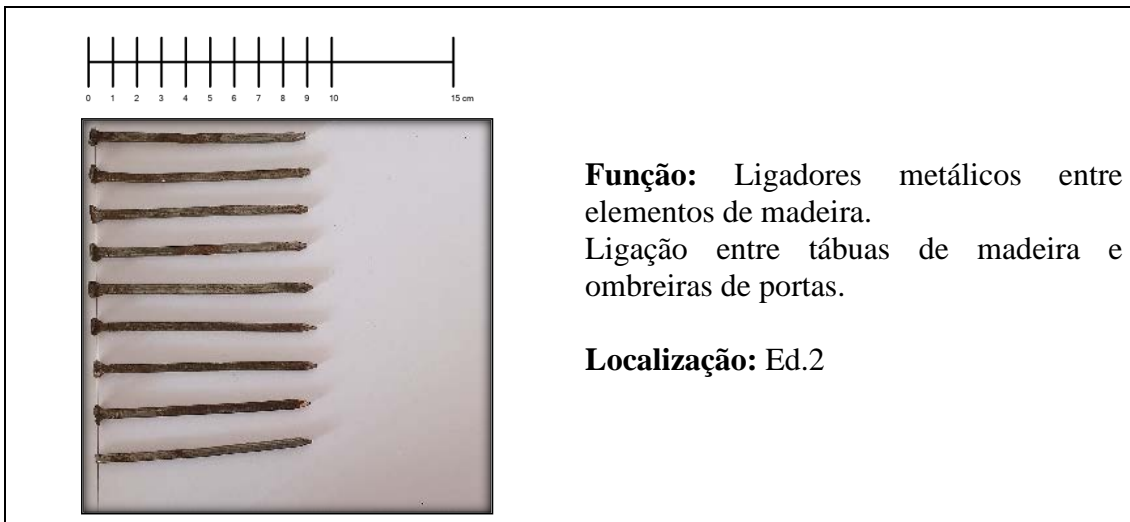
Figura 26: Ligadores metálicos de ligação entre tábuas de madeira e ombreiras de portas do Ed.2
