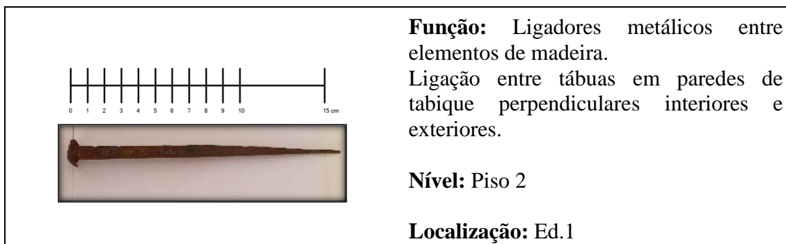
Figura 37: Ligadores metálicos de ligação de tábuas em paredes de tabique perpendiculares interiores e exteriores do Ed.2, piso 2
