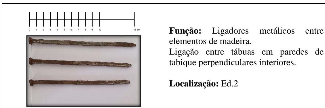
Figura 38: Ligadores metálicos de ligação de tábuas em paredes de tabique perpendiculares interiores do Ed.2
