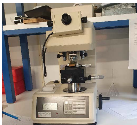
Figura 44: Aparelho utilizado para o ensaio de microdureza de Vickers
