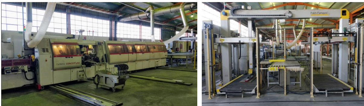
Figura 16 – Fotos Orladora Combima Concept e alimentador da entrada de painéis
