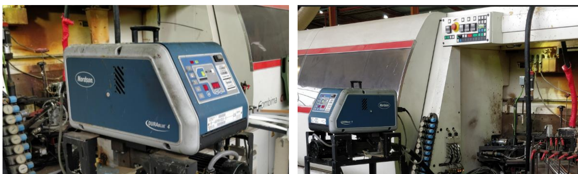
Figura 20 – Sistema Nordson de fundição e abastecimento do adesivo poliuretano
