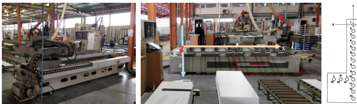
Figura 30 – Furadora Morbidelli U26 e cabeçote 1
