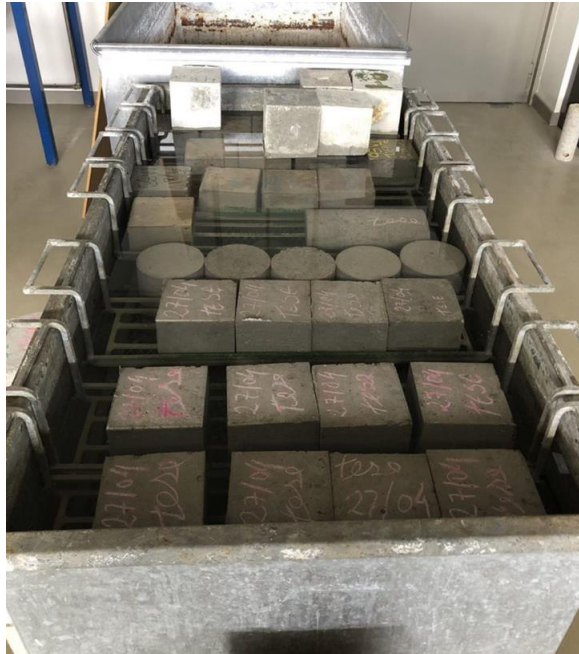
Figura 26 - Ensaio de Absorção de Água por Imersão Provete Cúbicos e Cilíndricos
