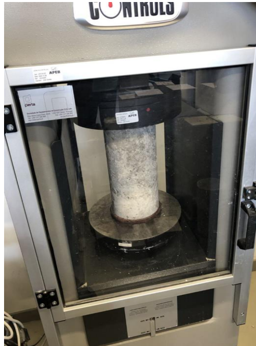
Figura 22 - Ensaio de Compressão de um Provede Cilíndrico
