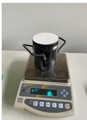
Figura 15 - Análise da Densidade do Pó de Polímero/Vidro
