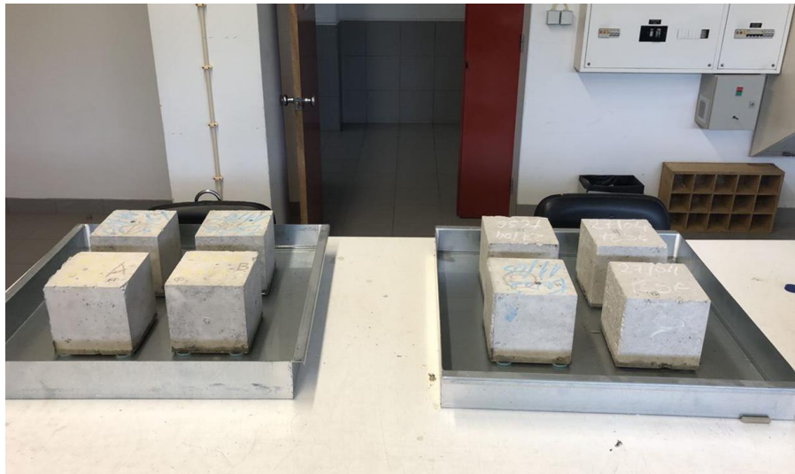
Figura 25 - Ensaio de Absorção de Água por Capilaridade em Provete Cúbicos Inicialmente, os provetes foram secos numa estufa ventilada a 40 \pm 5^\circ \text{C} durante 14 dias. O cálculo seguiu a equação seguinte:
