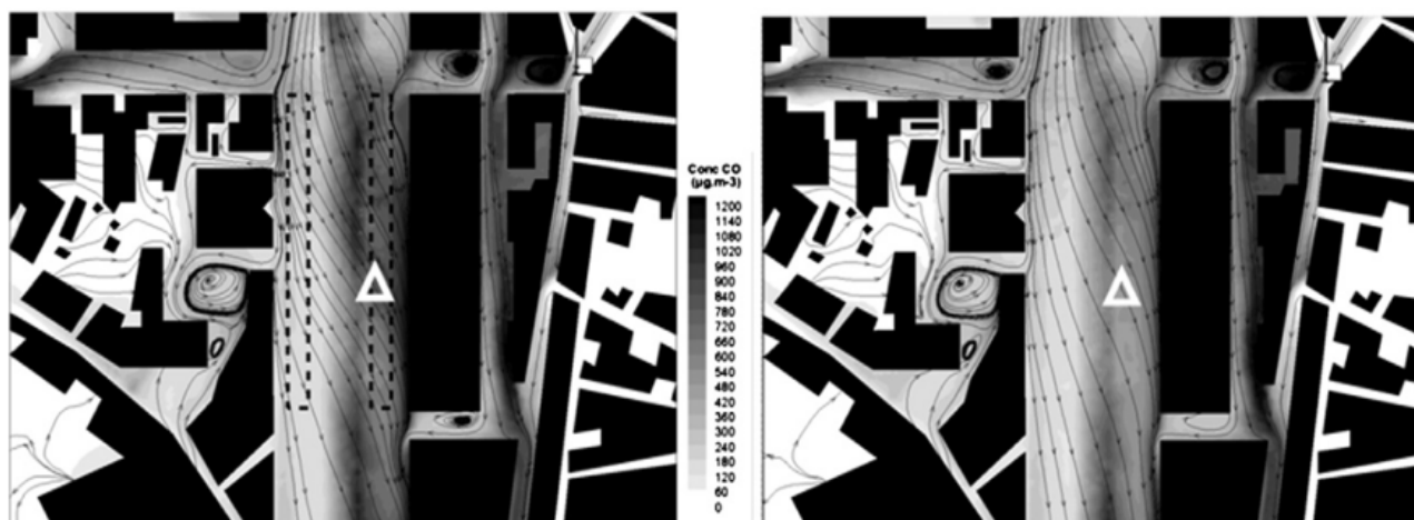
Figura 31 Detalhe em apenas uma área selecionada do plano de linhas de corrente horizontais a 3 m de altura e campo de concentração de CO com e sem o efeito de árvores em Lisboa. Os contornos referem-se ao período compreendido entre as 9h e as 10h. Os retângulos não preenchidos indicam blocos de árvores e o triângulo branco é a localização da estação RMQA da Av. da Liberdade (extraído de Amorim et al. , 2013).
