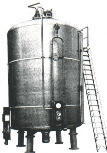
Figura 5. Acetificador Frings em aço inoxidável.
