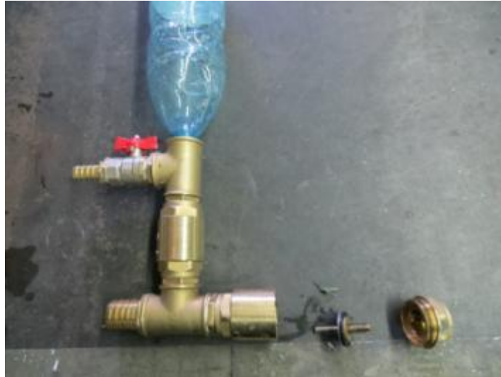
Figura 5–13: Carneiro hidráulico com garrafa PET.
