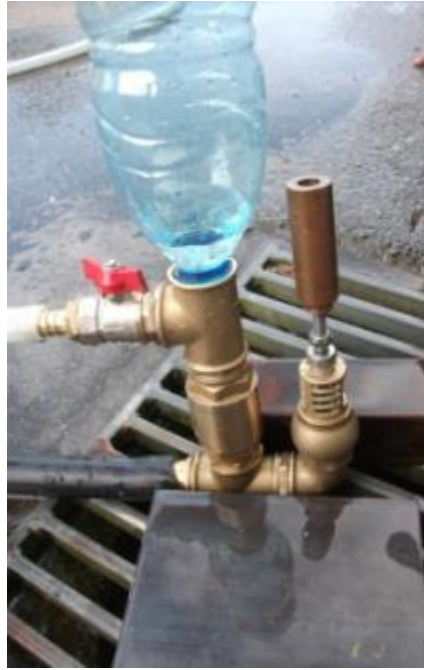
Figura 5-24: Ensaio do carneiro com pesos.
