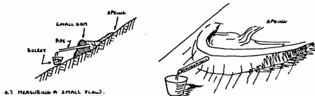
Figura 8–2: Exemplo de medição do caudal através do método volumétrico [36].
