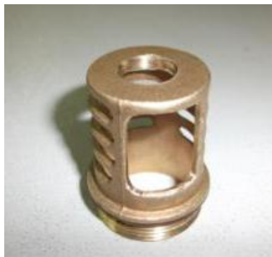
Figura 5–20: Aspecto final após perfurações.
