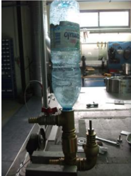
Figura 5-22: Válvula de impulso instalada no carneiro.
