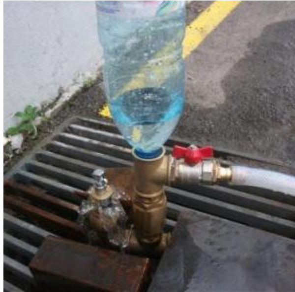
Figura 5–29: Teste do carneiro hidráulico.
