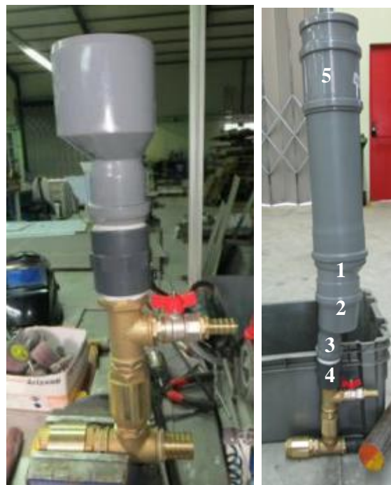
Figura 5-8: Montagem do carneiro.
