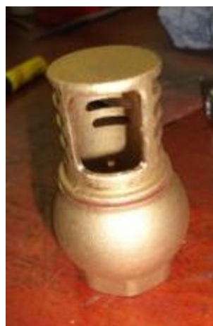
Figura 5–18: Corte efectuado na válvula de pé.
