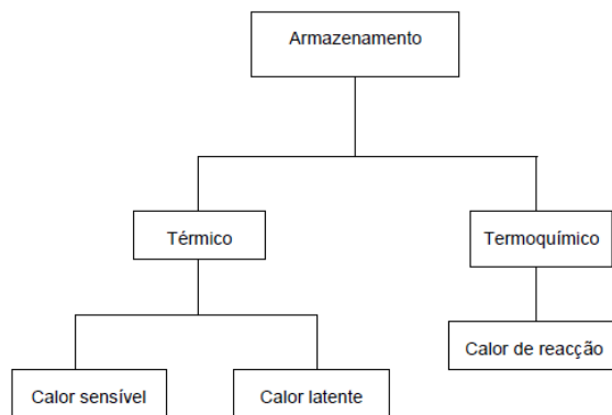
Figura 2-20: Armazenamento de energia térmica
