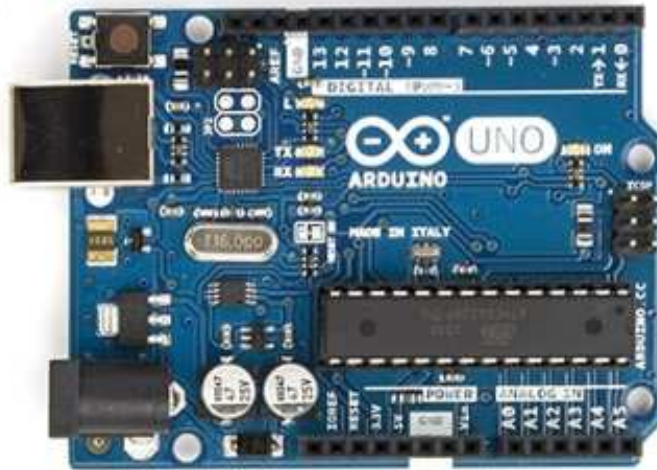
Figura 1 - Arduino UNO R3.
