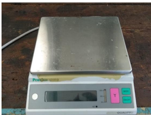
Figura 26 - Balança de precisão utilizada nos ensaios, Balança PRECISA modelo 6200D
