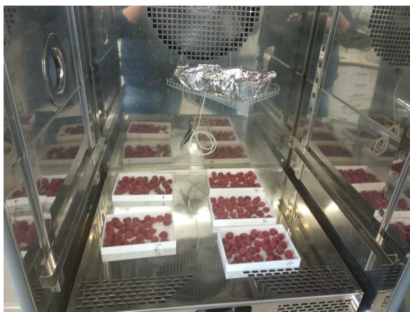
Figura 14 - Aparato para o ensaio de medição contínua do peso das amostras.
