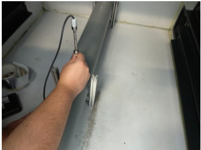
Figura 43 - Ensaio de determinação do caudal de ar
