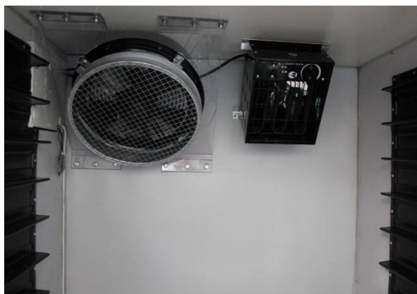
Figura 21 - Resistência e ventilador interior do secador
