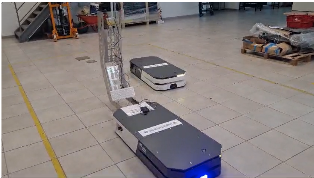
Figura 4.26: Zona intermediária para passagem de kit entre AMR
