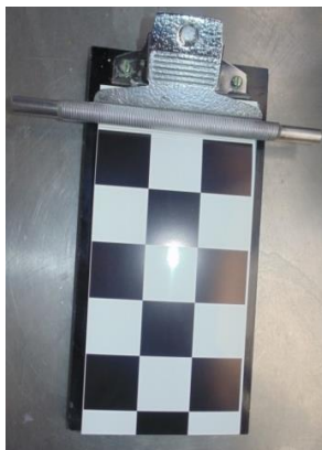
Figura 8-6: Aplicador estriado e cartão quadriculado.
