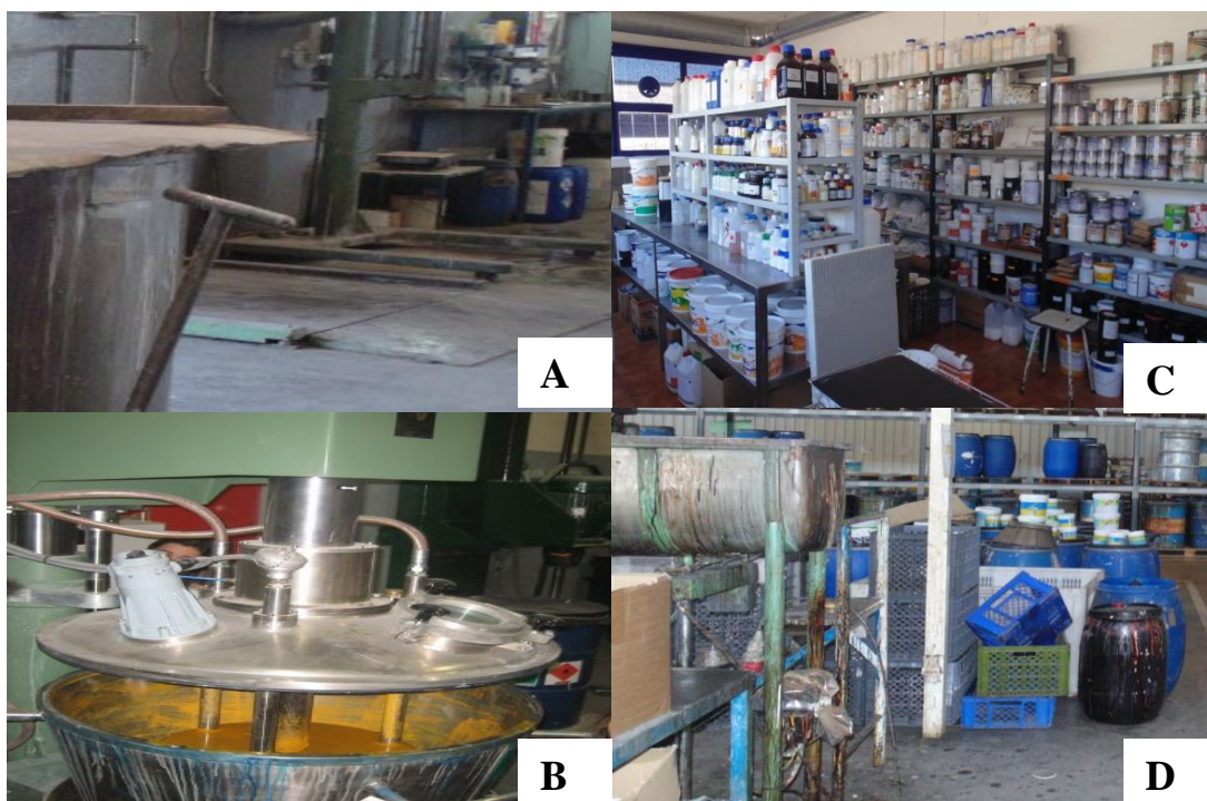
Figura 3-4: Linha de produção de tintas de base-solvente: A-Pesagem/Dosagem B-Mistura/Dispensão, C-Controlo da Qualidade e Acertos Finais, D-Enchimento e Rotulagem.
