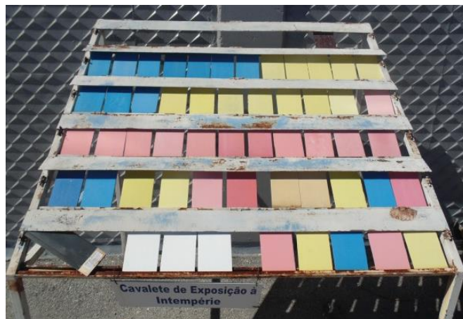
Figura 8-9: Cavalete de exposição à intempérie.
