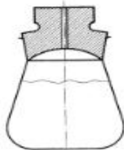
Figura 2b) – Pícnometro Hubbard
