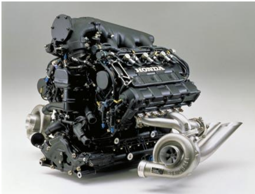
Figura 118 – Motor Honda RA 168 E (Auteoch, 2013).
