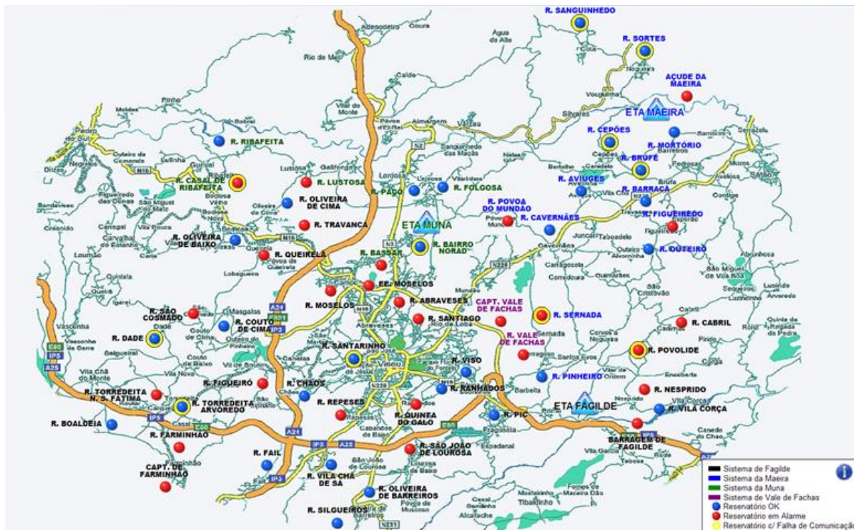
Figura 4-5: Exemplo de Monitorização da rede de abastecimento com o Sistema de Telegestão, em tempo real. Fonte: SMAS de Viseu.
