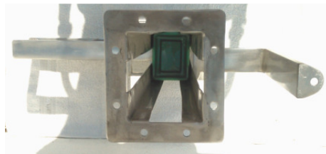
Figura 2.14. Orifício de abastecimento da torre
