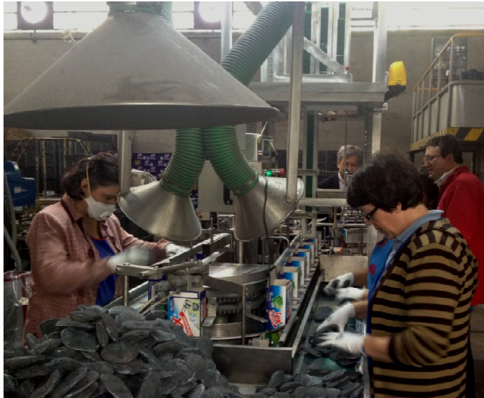
Figura 4.3. Linha de abastecimento e embalagem de esfregões em produção
