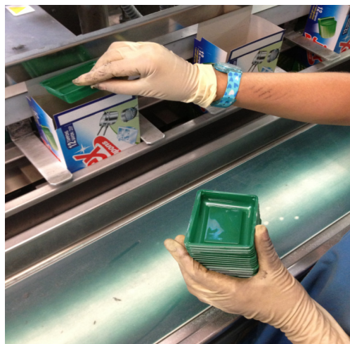
Figura 4.1. Abastecimento manual de escorredores
