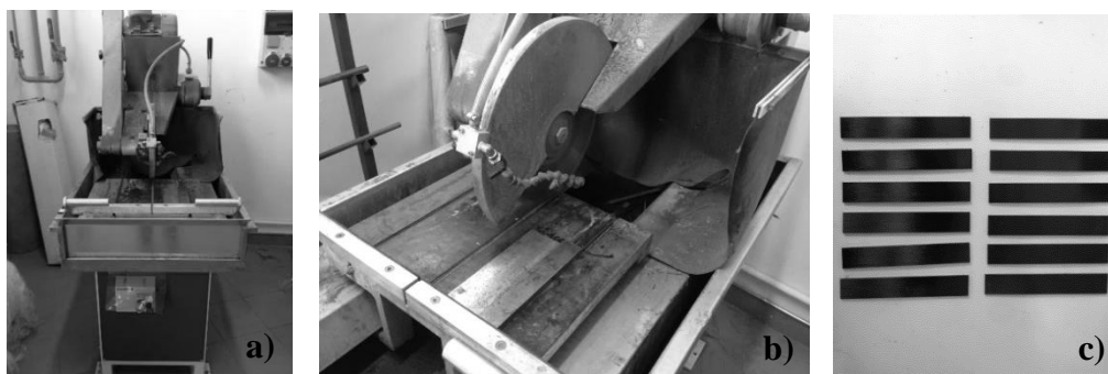
Figura 42: a) Máquina de disco de corte (ISEP); b) Pormenor da mesa deslizante do disco de corte e do sistema de refrigeração; c) Provetes.
