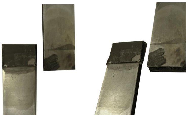
Figura 73: f) Falha das superfícies das juntas com uma espessura do aderente de 6,4 mm e com um tratamento da superfície pelo método ataque com ácido.
