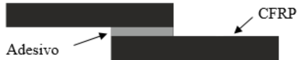
Figura 74: Configuração da junta de referência CFRP, com um comprimento de sobreposição de 50 mm.
