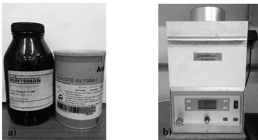
Figura 17: a) Adesivo AV138M e endurecedor HV 998; b) Máquina misturadora (SpeedMixer).
