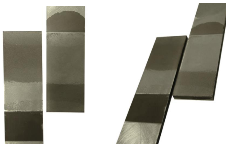
Figura 87: a) Falha das superfícies das juntas com uma espessura do aderente de 3,2 mm e com um tratamento da superfície pelo método de lixagem.
