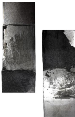
Figura 91: e) Falha das superfícies das juntas com uma espessura do aderente de 6,4 mm e com um tratamento da superfície pelo método de anodização.
