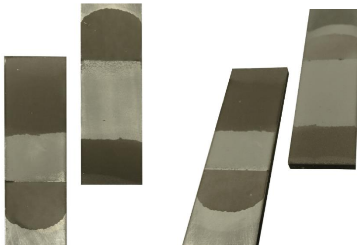
Figura 93: c) Falha das superfícies das juntas com uma espessura do aderente de 3,2 mm e com um tratamento da superfície pelo método por ataque com ácido.
