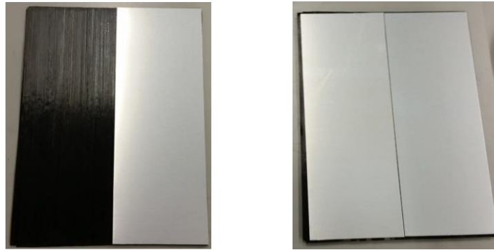
Figura 35: Empilhamento das placas de alumínio com as placas de CFRP.
