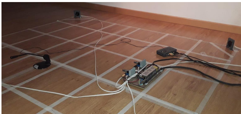
Figura 3-15: Foto parcial do sistema implementado, é possível ver os amplificadores, 2 dos speakers , placa de som e microfone.
