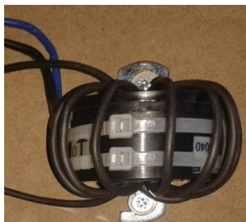
Figura 3-36: Transformador de intensidade usado na leitura de corrente AC.
