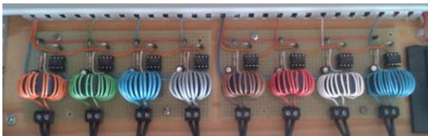
Figura 4-10: Detalhe de montagem dos circuitos de medição da corrente dos circuitos do sistema de simulação de consumo.
