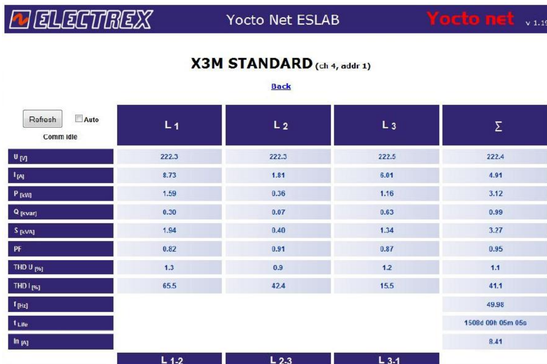
Figura 3-29: Leitura de grandezas, via browser , de um analisador.
