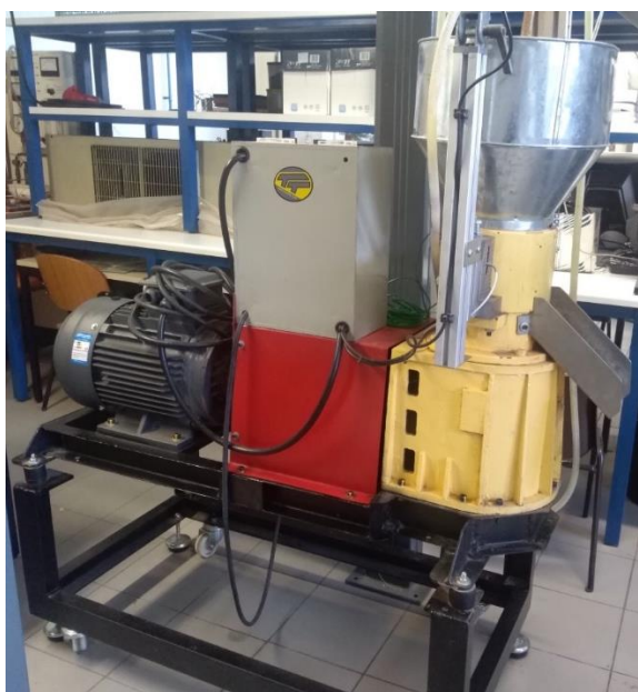
Figura 6.1- Peletizadora utilizada no trabalho experimental.
