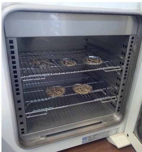
Figura 6.3- Processo de secagem dos péletes em estufa laboratorial.
