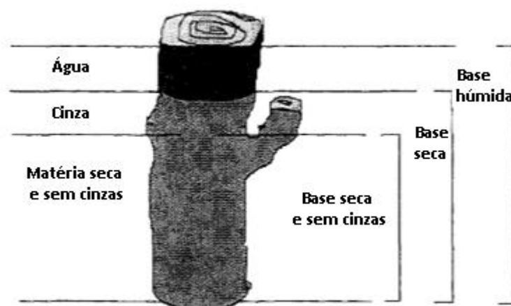
Figura 2.2- Composição da biomassa – Adaptado de Quaak, et al., 1999.
