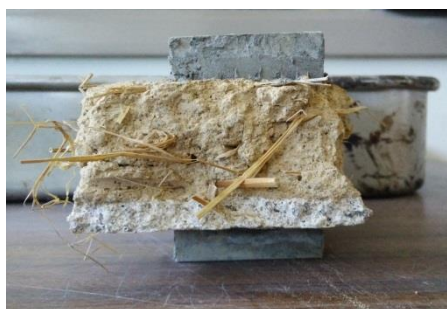
Figura 4-28: Aspeto da amostra de argamassa pronta para ensaiar
