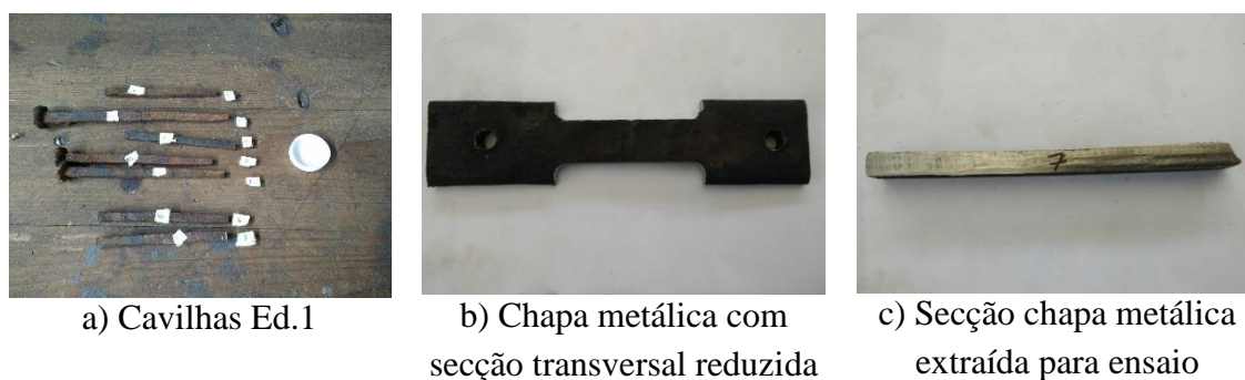
Figura 4-1 Pregos e chapas metálicas utilizados nos ensaios
