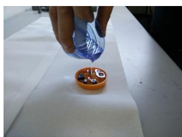
a) Colocação de resina nos moldes
