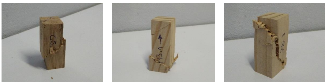
Figura 4-20: Exemplo de alguns tipos de rotura observados
