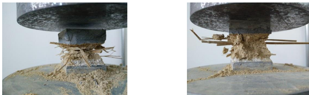
Figura 4-31: Aspeto das amostras na zona de rotura
