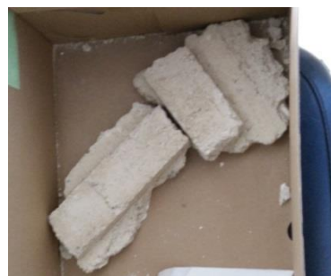
a) Amostra de argamassa calcária
