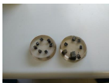
b) Moldes após endurecimento da resina
