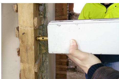
a) Ensaio do Resistógrafo – Fase Inicial
