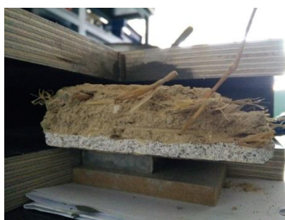
Figura 4-25: Aspeto das amostras de argamassa recolhidas no Ed.1
