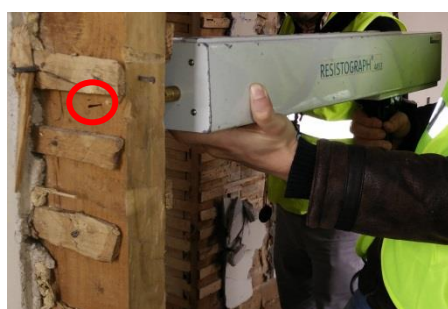
b) Ensaio do Resistógrafo – Fase Final
