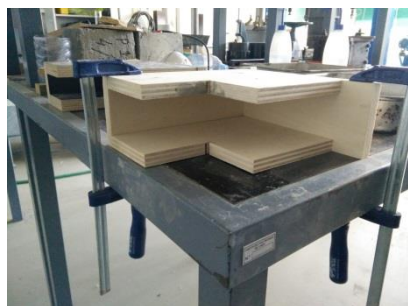
c) Engenho de auxílio ao alinhamento dos prismas d) Pormenor da colagem do segundo prisma
