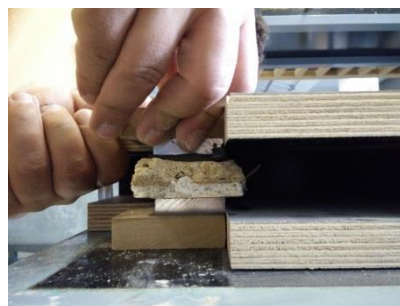
c) Engenho de auxílio ao alinhamento dos prismas d) Pormenor da colagem do segundo prisma
