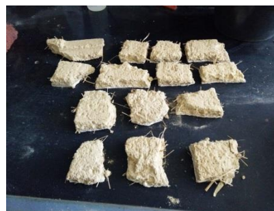
b) Amostra após corte, nivelamento e limpeza
