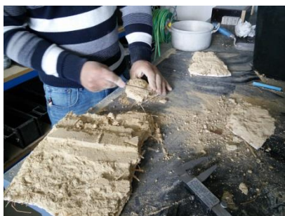
a) Divisão de uma placa de revestimento em amostras mais pequenas
