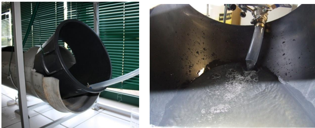
Figura 9-6 – Fotografias da rampa instalada, a montante da conduta, para promover um escoamento mais linear na entrada da água na conduta.
