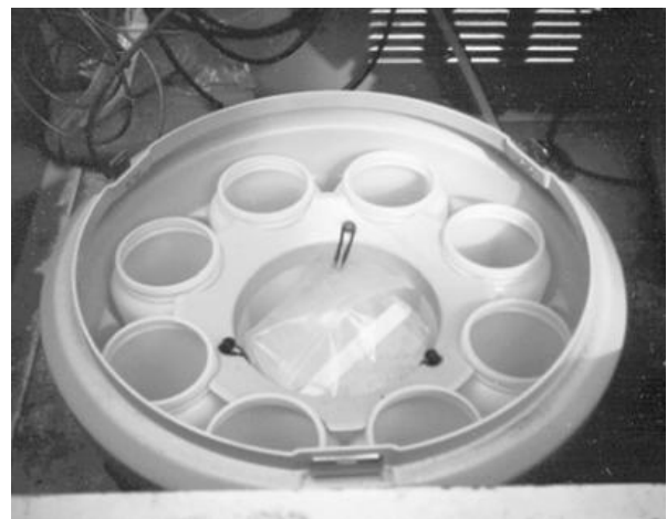
Figura 4-2 Configuração dos recipientes no mostrador automático. a) configurado para um único recipiente de amostra; b) configurado para vários recipientes de amostras. (Fonte: Caltrans, 2003).
