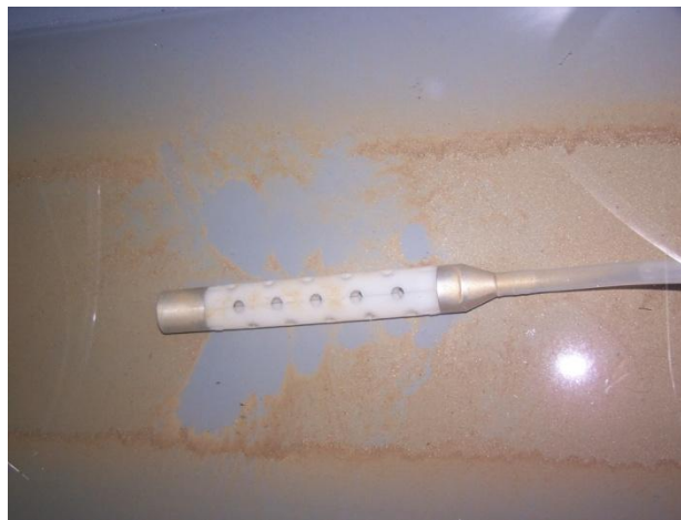
Figura 9-11 – Efeito da purga do tubo de sucção sobre os sólidos sedimentados na base da conduta.
