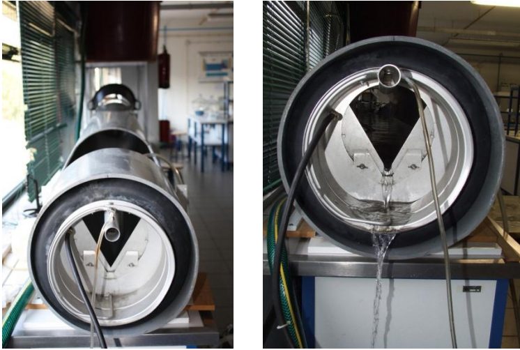
Figura 9-9 – Fotografias do descarregador montado no final da conduta.
