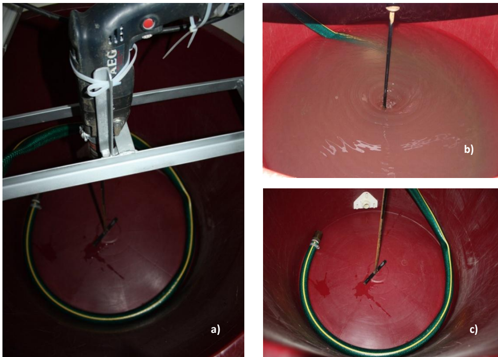
Figura 9-3 – Fotografias do pormenor do sistema de agitação no tanque de abastecimento, a montante da conduta e da posição da mangueira no depósito. a) sistema elétrico de agitação, suspenso sobre o tanque; b) sistema de agitação da água em funcionamento; c) pormenor do posicionamento da mangueira no fundo do depósito.
