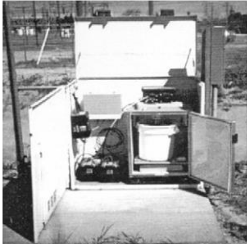
Figura 4-4 – Estação de monitorização automática (Caltrans, 2003).
