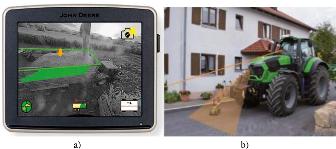
Figura 3 - a) Visão ao carregar; b) Visão do ponto cego do trator. Fonte: [8].
