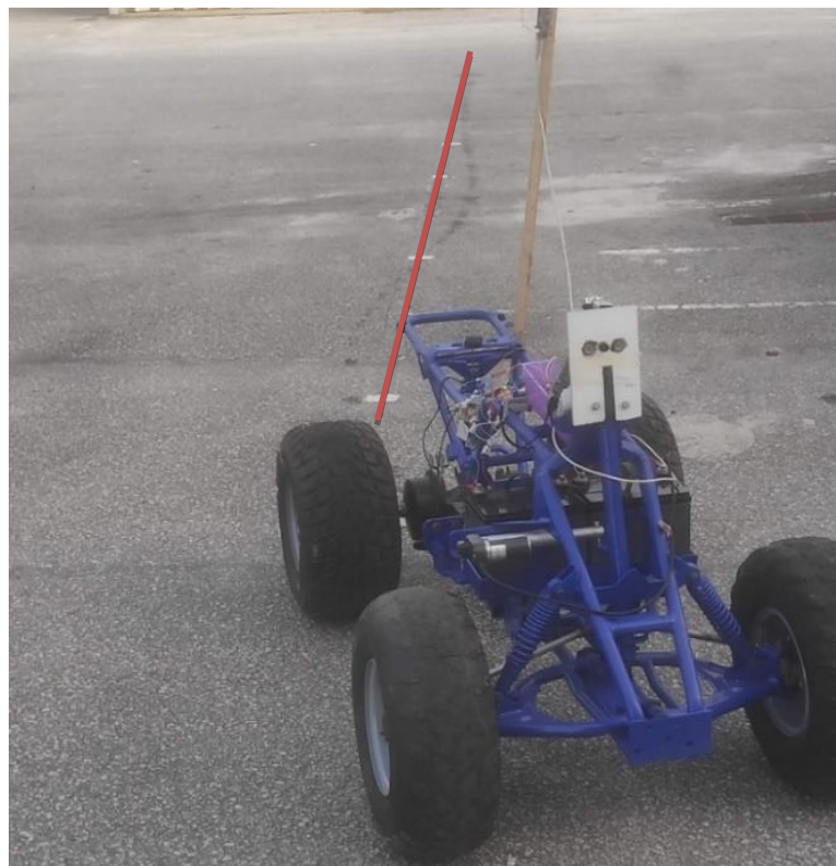
Figura 49 - Teste realizado ao desvio existente durante a movimentação do robô alinhado com o objeto.
