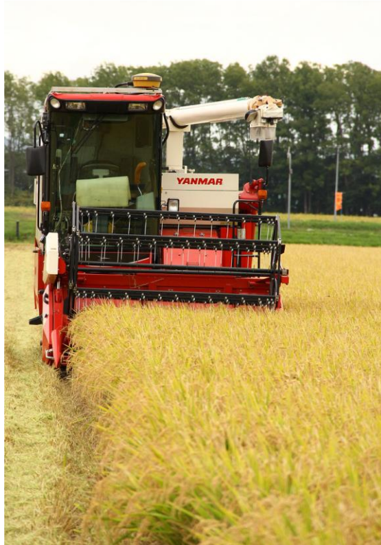
Figura 4 – Ceifeira equipada para condução autónoma. Fonte: [9].
