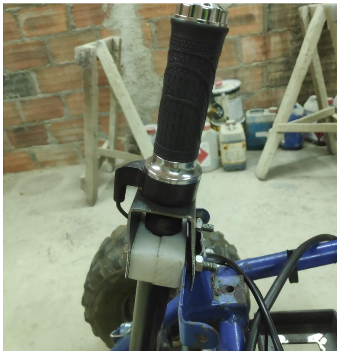
Figura 28 – Ilustração onde se encontra posicionado o sensor de hall no robô.
