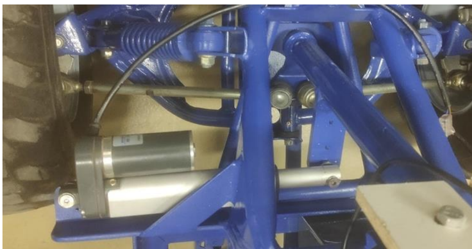
Figura 20 – Sistema de direção implementado com suporte e motor utilizado.
