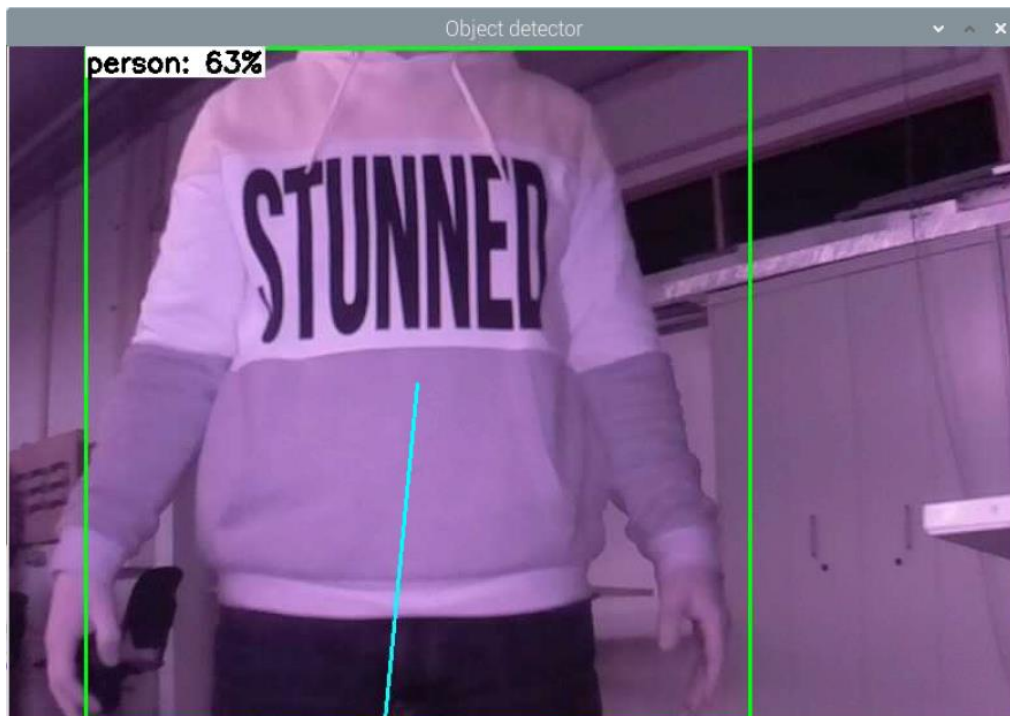
Figura 43 – Funcionamento da deteção com a pessoa perto do robô, ou seja, em situação de paragem.
