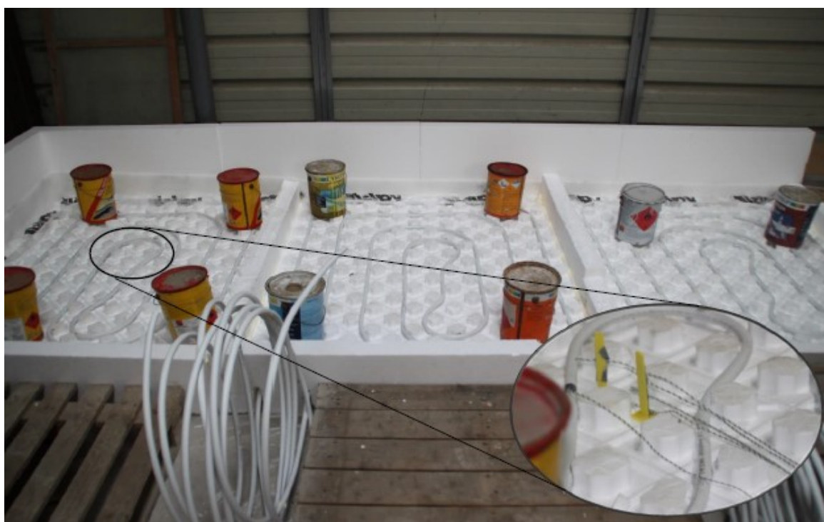
Figura 19 - Setup experimental - colocação dos tubos e termostatos (Rodrigues, 2019)
