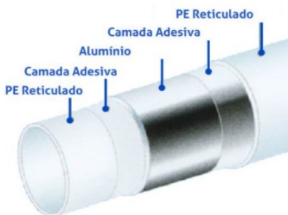
Figura 12 - Composição tubo PEX (MACOP, 2019)
