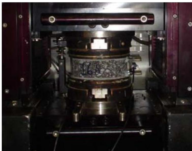
Figura 2-10: Equipamento com um provete para a realização do ensaio de corte simples a altura constante RSST-CH da Universidade do Minho (Fontes et al. , 2008)
