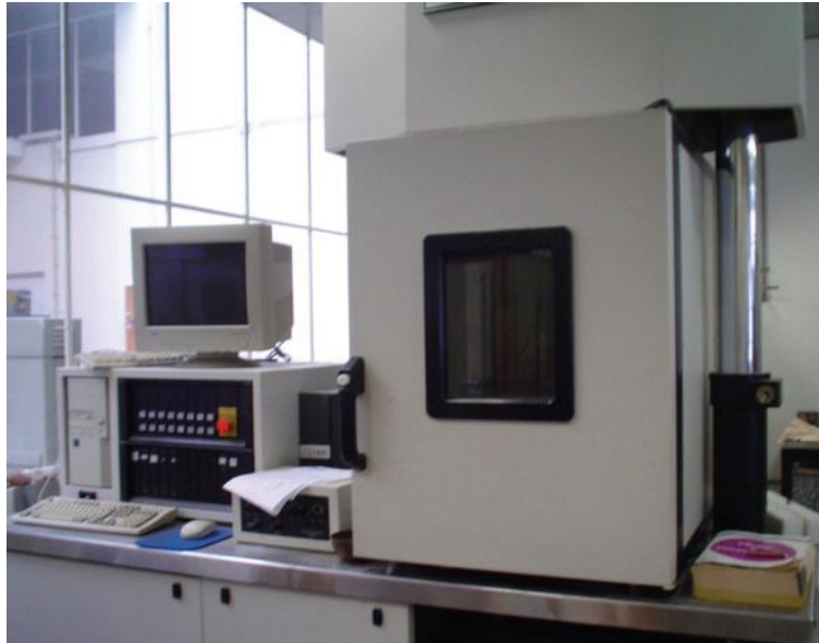
Figura 2-7: Equipamento servo-hidráulico para a realização dos ensaios de flexão alternada (Fontes et al. , 2009)
