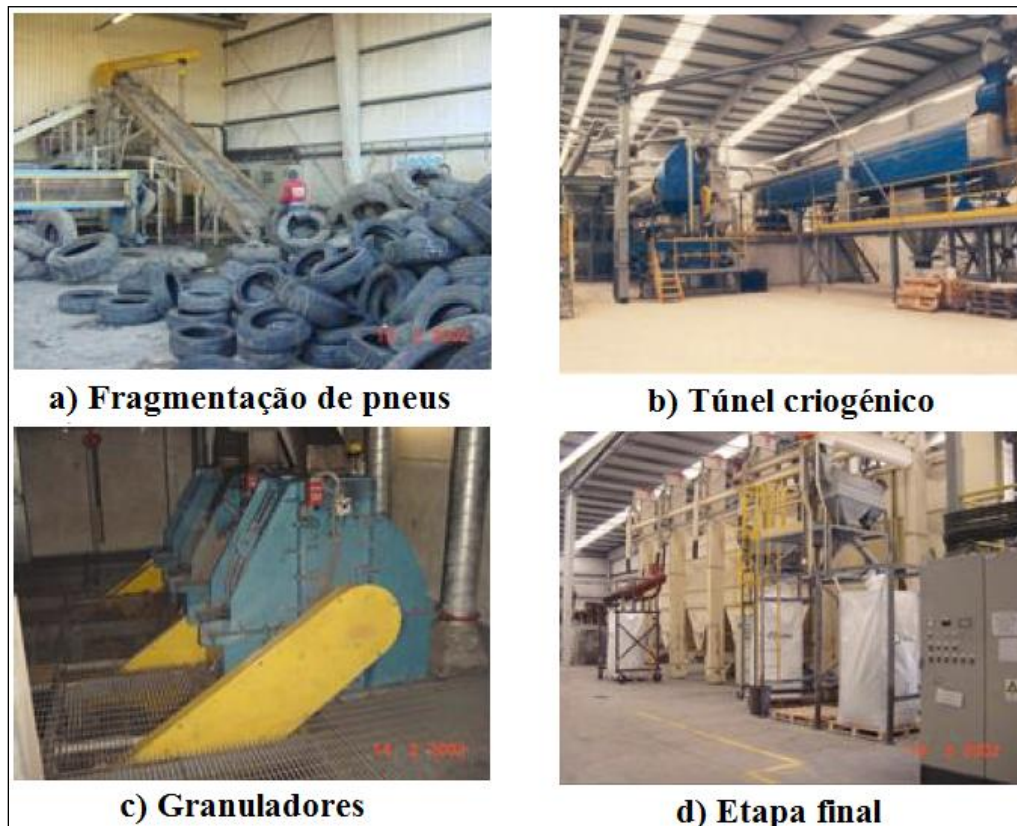
Figura 3-8: Processo criogénico (Neto et al. , 2006)
