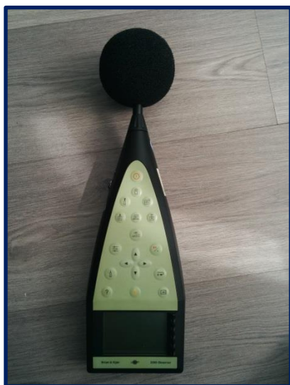
Figura 27 - Sonómetro Bruel & Kjaer 2260 Observer.
