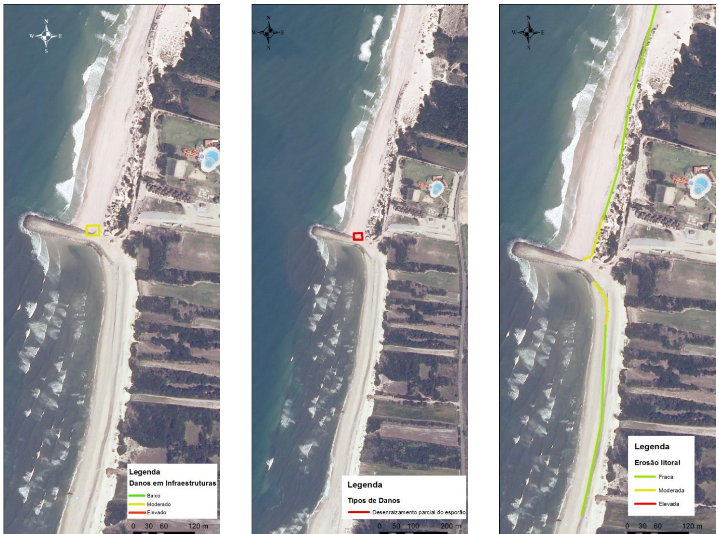
Figura 11- Caracterização dos danos e susceptibilidade à erosão litoral na praia do Labrego.
