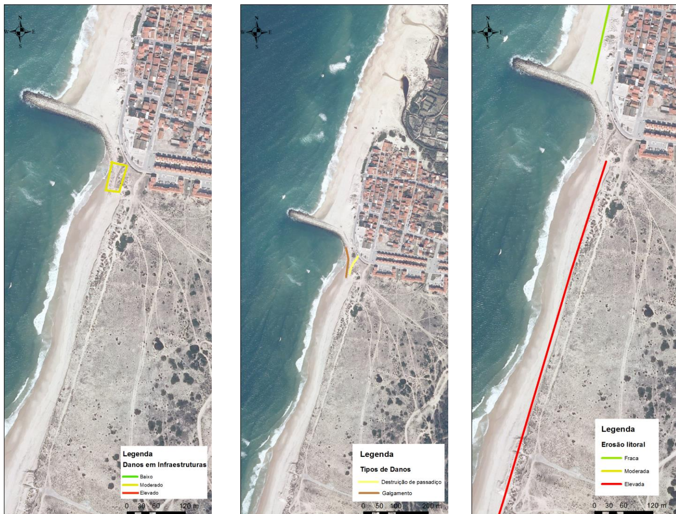
Figura 19- Caracterização dos danos e susceptibilidade à erosão litoral na praia da Leirosa.
