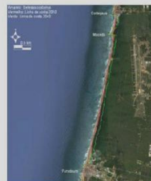
A linha verde indica o recuo previsto da costa em 2040, entre Cortegaça e Furadouro, enquanto a vermelha está assinalado o limite atual
