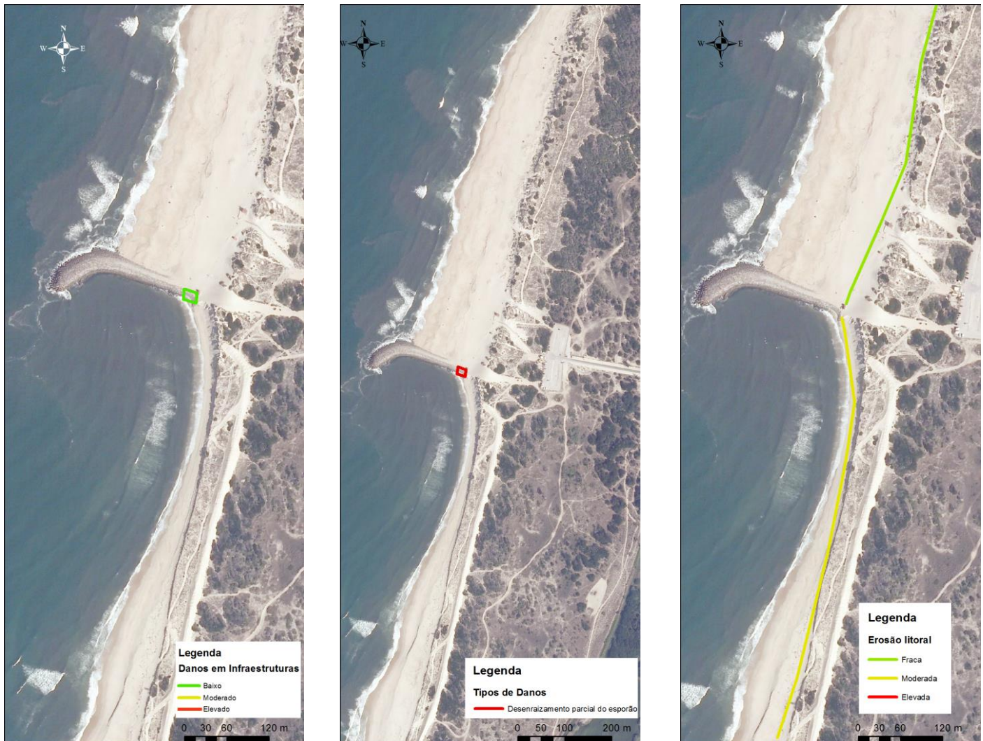
Figura 13- Caracterização dos danos e susceptibilidade à erosão litoral na praia da Poço da Cruz.
