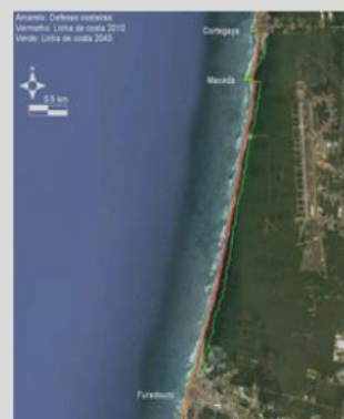
A linha verde indica o recuo previsível da costa em 2040, entre Cortegaça e Furadouro, enquanto a vermelha está assinalado o limite atual
