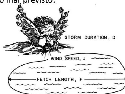
Figura 2- Factores importantes na geração de ondas de vento, adaptado de Komar, 1988
