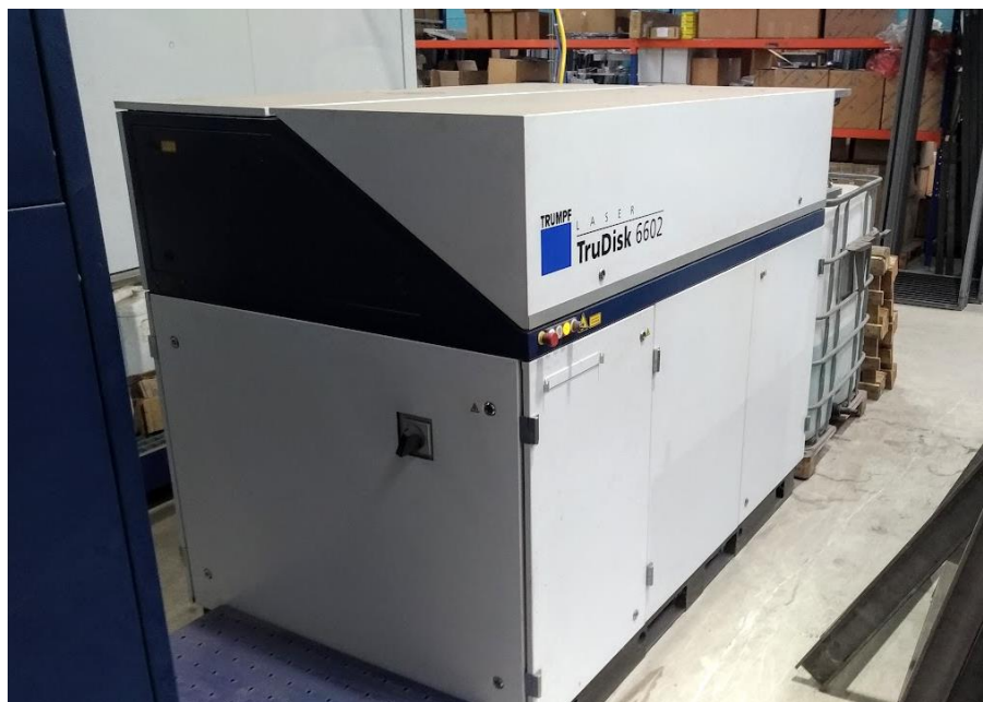
Figura 35 Fonte do feixe laser Trumpf TruDisk 6602.
