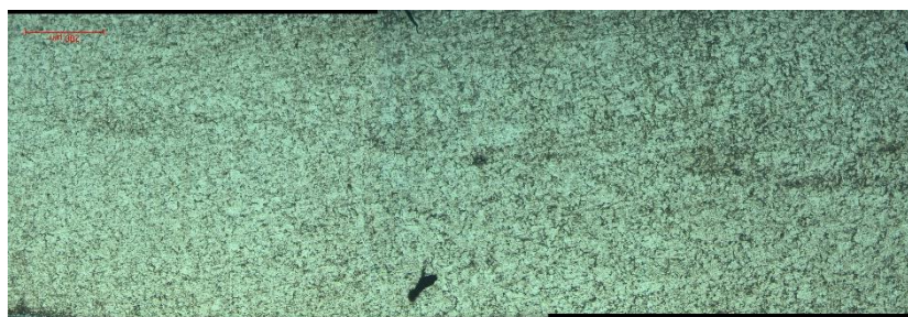
Figura 67 – Perfil longitudinal do cordão de soldadura da amostra 7.
