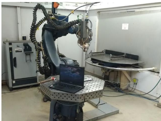
Figura 37 Robot e mesa central de fixação.
