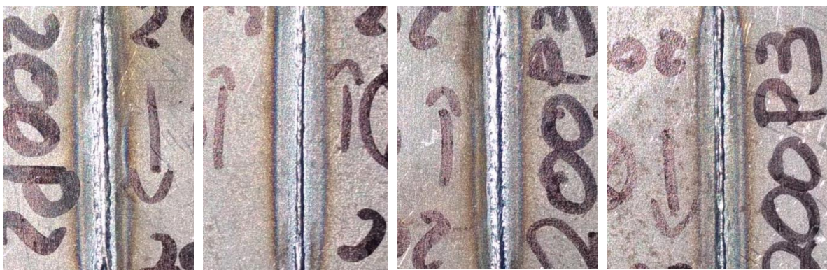
Figura 62 – Superfícies superior e inferior dos cordões da amostra B e C.
