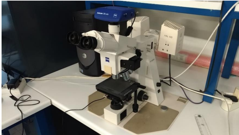
Figura 29 – Microscópio Axiotech 100 equipado com a câmara Axiocam 2008 color
