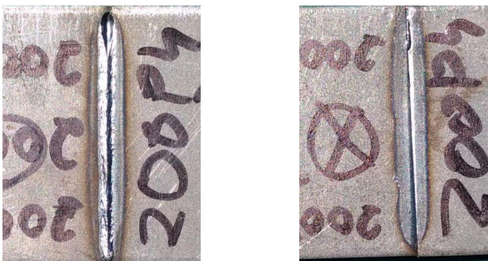
Figura 63 – Superfície superior e inferior do cordão de soldadura da amostra D.
