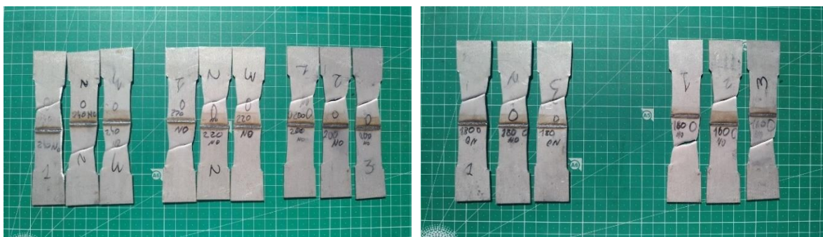
Figura 49 - Provetes das amostras 5 a 1, da esquerda para a direita respetivamente, utilizados nos ensaios de tração.
