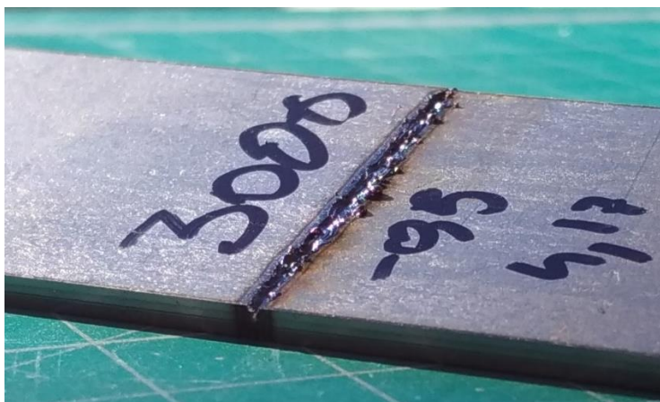
Figura 94 – Detalhe das gotículas depositadas e respingado para a soldadura por laser pulsado com altura focal negativa e potência de pico de 3000 W.
