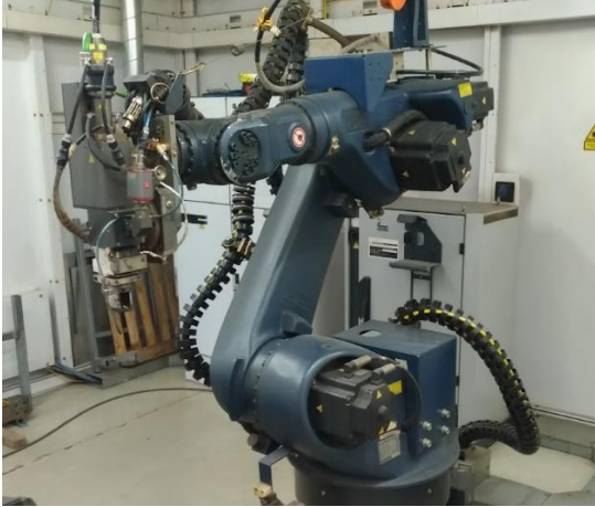
Figura 39 - Robot com ótica de focagem.
