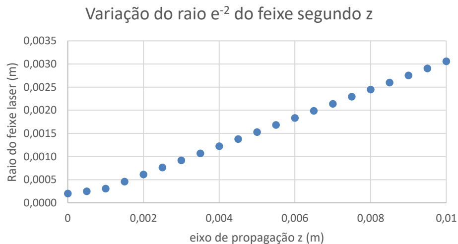
Figura 41 - Variação do raio do feixe laser segundo o eixo z
