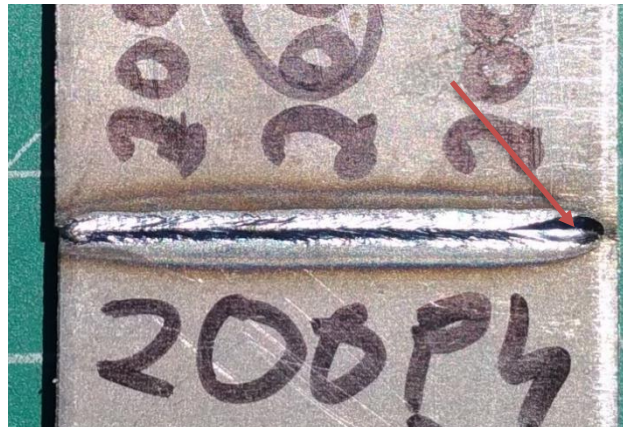
Figura 44 – Vista superior de um cordão de soldadura com a depressão visível no final do cordão
