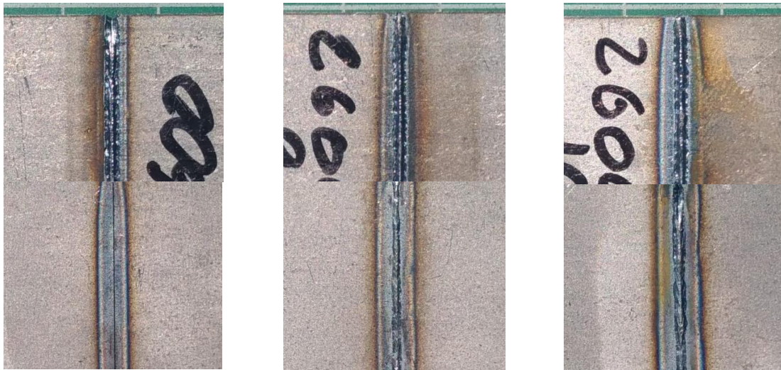
Figura 83 – Superfície superior, acima, e inferior, em baixo, dos cordões das amostras K, L e M, da esquerda para a direita respetivamente.
