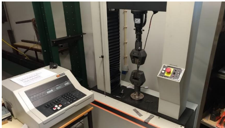
Figura 30 - Preparação de um ensaio de tração.
