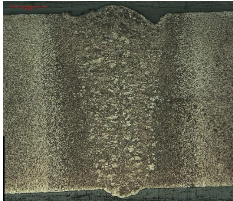
Figura 87 – Perfil transversal do cordão da amostra H.
