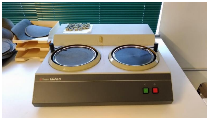
Figura 28 - Equipamento de polimento Struers LaboPol-21
