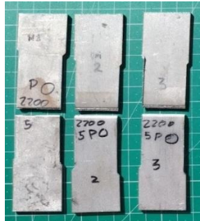
Figura 80 – Modo de rutura nos provetes da amostra E.
