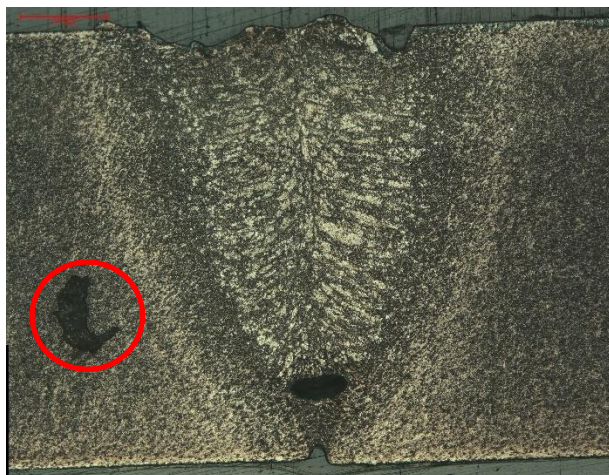
Figura 98 – Perfil transversal do cordão da amostra Q.
