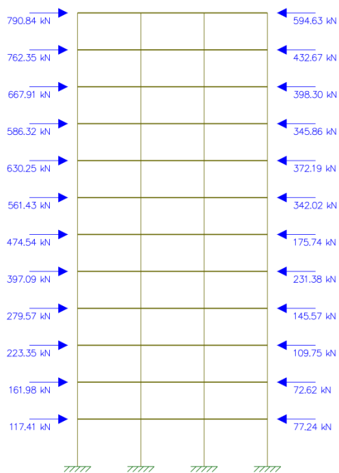
Figura D-17: Modelo plano do pórtico PA no 1º modo de vibração
