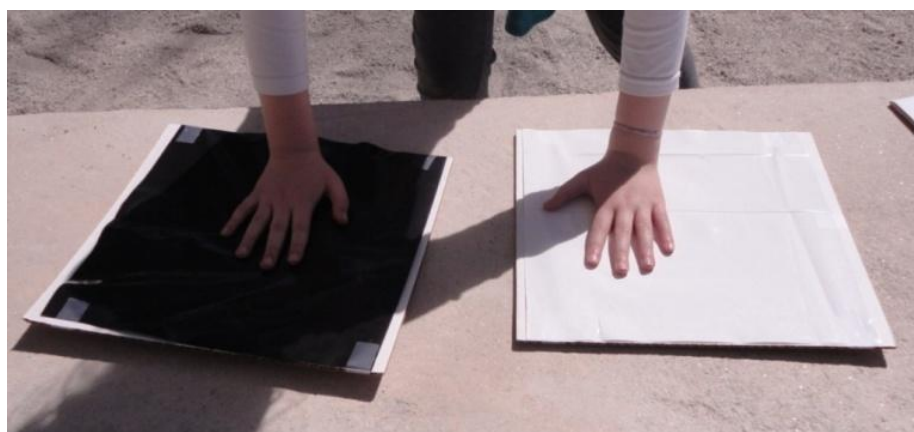
Figura 31: Diferenças de temperatura entre um plástico branco e outro preto.
