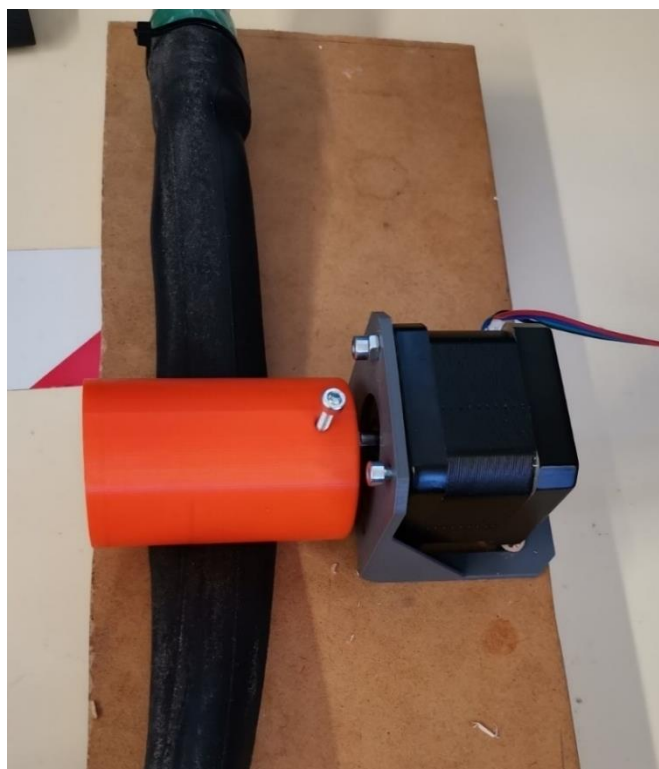
Figura B-1: Primeira versão da válvula PEEP.
