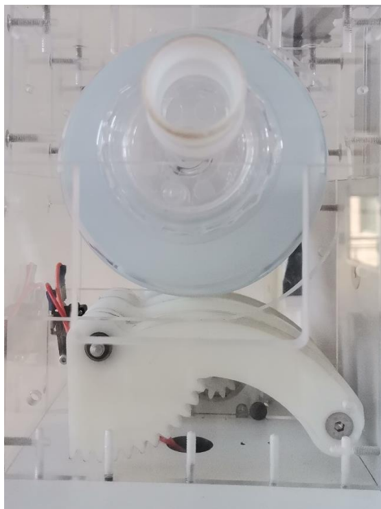
Figura 3-4: Vista lateral do AMBU e do mecanismo para compressão e descompressão do balão insuflável.
