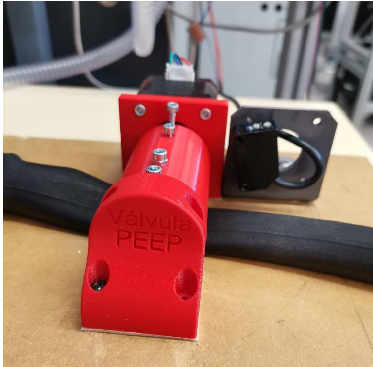
Figura B-2: Segunda versão da válvula PEEP.
