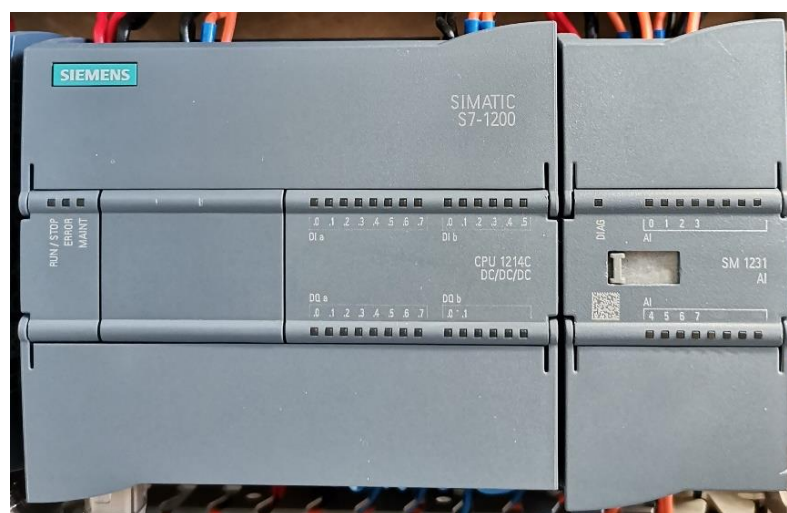
Figura 3-5: PLC S7-1200, CPU 1214C DC/DC/DC e módulo de expansão de entradas analógicas SM1231.
